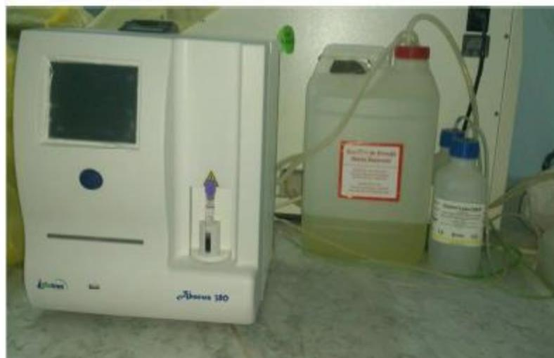
Figure 31: Un automate d'Abacus 380 à 19 paramètres.
