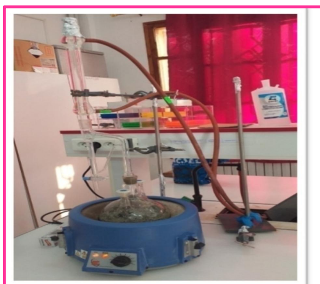
Figure 15: Montage d'hydrodistillation de type clevenger
