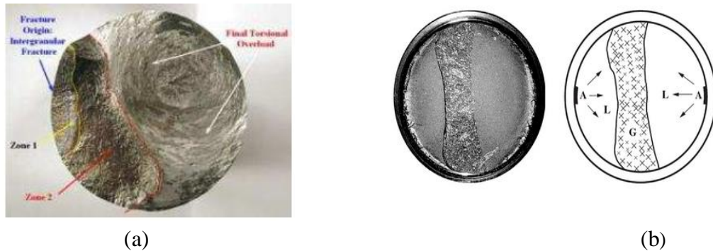
Figure I.3 : (a): Faciès de rupture d'un arbre de transmission de voiture de .course. (b) : Faciès de fatigue d'un arbre épaulé sollicité en flexion plane alternée, A : zone d'amorçage, L: zone lisse de propagation des fissures; G: zone accidentée de rupture.
