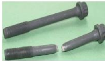
Figure 6. Rupture d'un tirant
