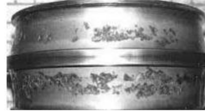
Figure I.12: Détérioration d'une bague de roulement
