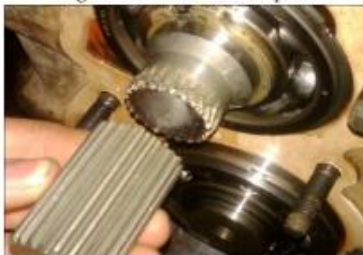
Figure 7. Rupture d'un arbre cannelé
