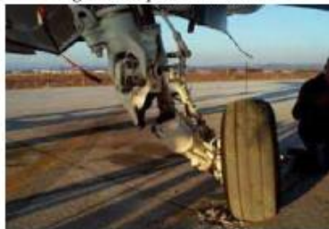
Figure 8. Fissuration au niveau du mécanisme d'atterrissage d'un avion
