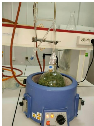
Figure 09 : Hydrodistillation de l'huile essentielle de Rutamontana par un dispositif de type Clevenger ( Photo personnelle, 2021 ).
