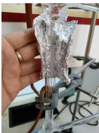
Figure 11 : L'accumulation de l'huile essentielle dans l'ampoule de décantation ( Photo personnelle, 2021 ).
