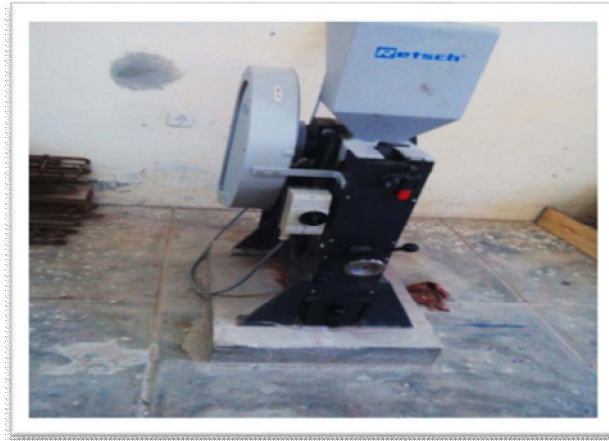
Figure IV.2 : Broyeur électrique (Retsch)
