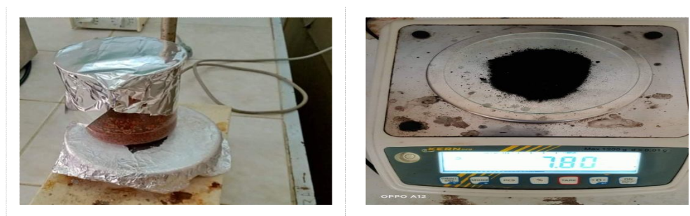
Figure IV.6: Les différentes étapes de l'activation chimique par l'acide phosphorique
