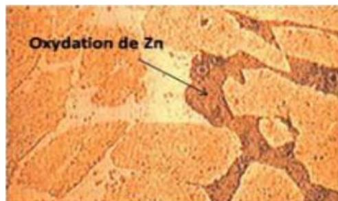
**Figure I.2 :** Corrosion sélective d'un laiton (alliage cuivre-zinc).
