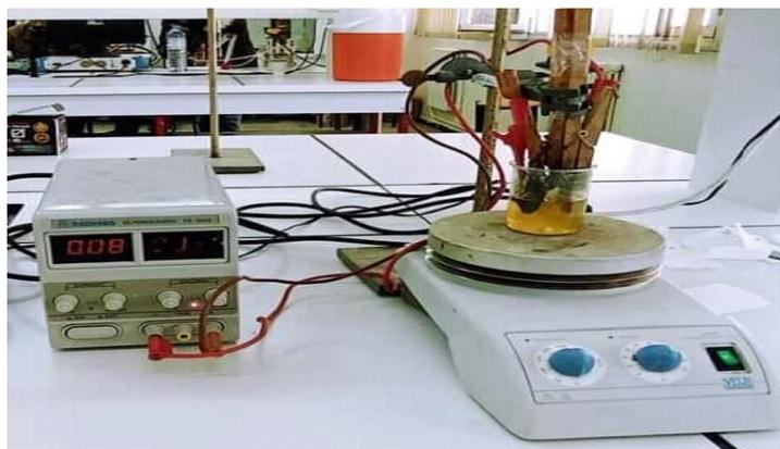
**Figure II.5 :** Montage d'électrodéposition avec AM.
