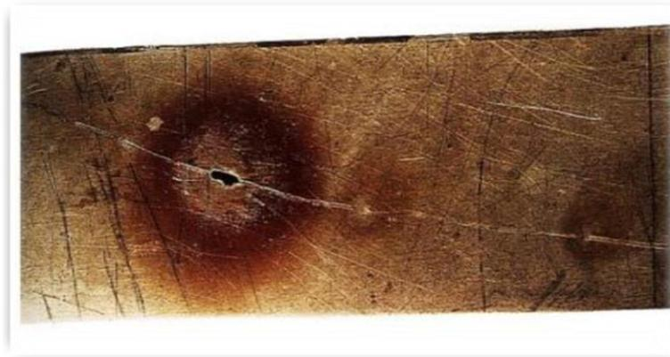
**Figure I.7 :** Corrosion par piqûres sur la paroi d'une cuve en acier inoxydable.
