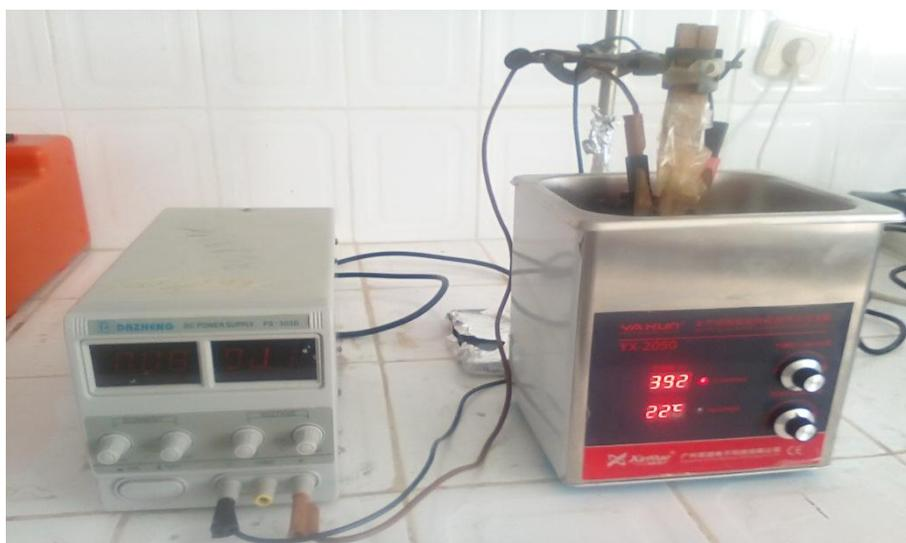
**Figure II.6 :** Montage d'électrodéposition avec AU.
