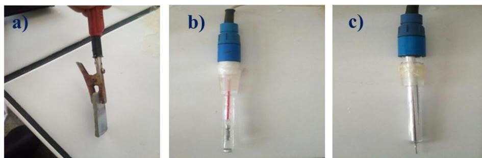
**Figure II.10 :** Les électrodes : a) électrode de travail, b) électrode de référence, c) électrode de auxiliaire.
