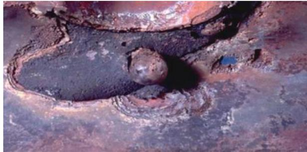
**Figure I.3 :** Corrosion galvanique au niveau d'une zone de brasage entre la brasure Cu-P et le tube en cuivre.
