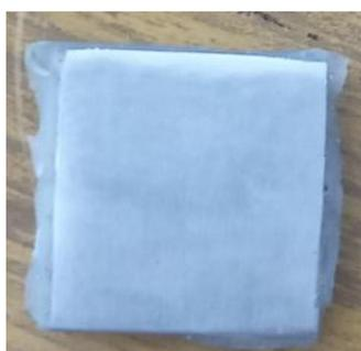
**Figure II.4 :** Plaque d'acier avec la résine sur l'une des faces.
