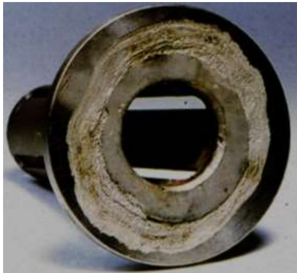
Figure I.7 : Corrosion par crevasse sous un joint
