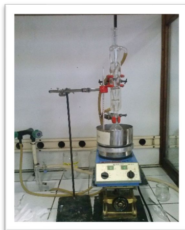
Figure I.12 : Montage d'hydro distillation.
