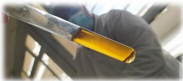
**Figure 38:** Test de présence des trichlorures
