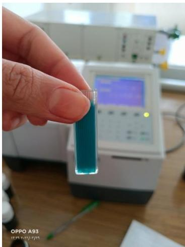
**Figure 57:** Cuve d'absorption par spectrophotomètre UV-V
