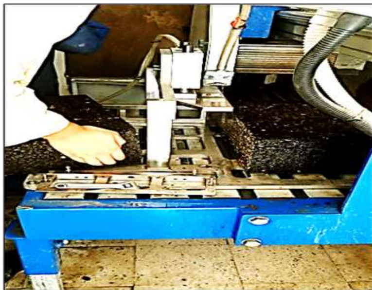
Fig. V.25. Opération de coupage d'une plaque de fatigue.
