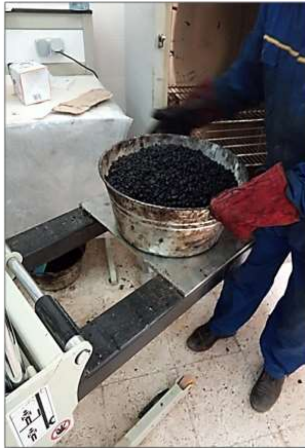
Fig. V.20. Transporte du mélange bitumineux
