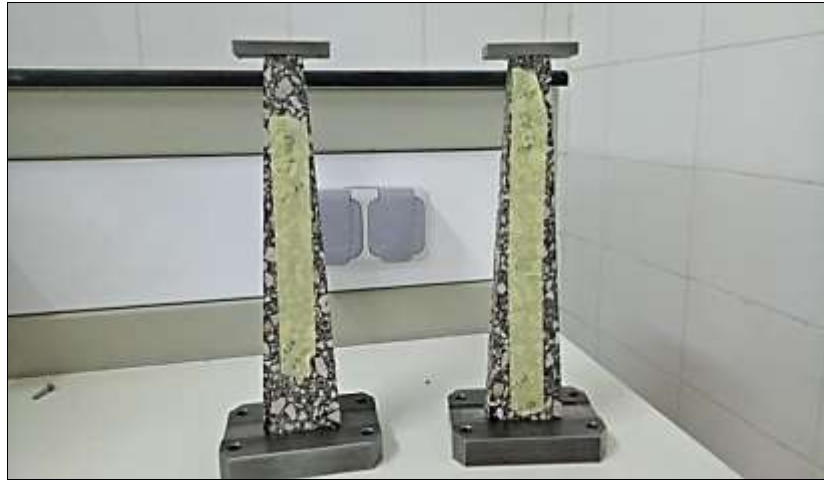
Fig. V.26. Fixation des éprouvettes trapézoïdales à la base
