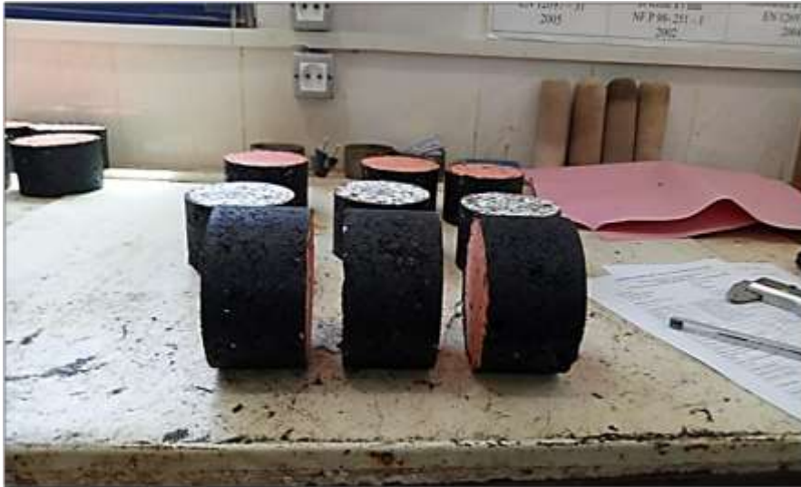
Fig. V.21. Éprouvette de l'essai Marshall
