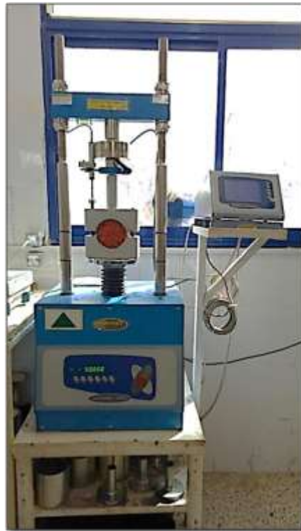
Fig. V.22. Éprouvette dans la presse de compression Marshall
