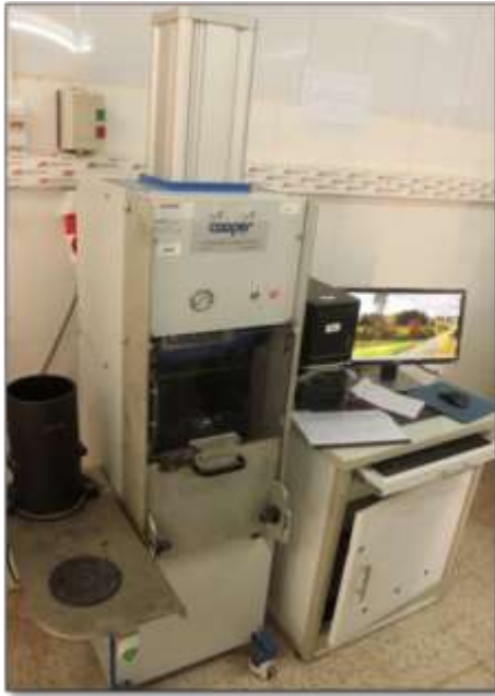
Fig. V.8. Essai la presse à cisaillement giratoire Fig. V.9. Extraction d'éprouvettes de PCG
