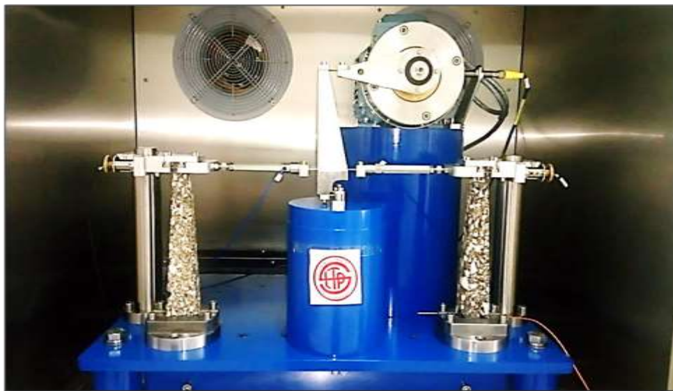
Fig. V.27. Les éprouvettes trapézoïdales placées dans la machine de flexion
