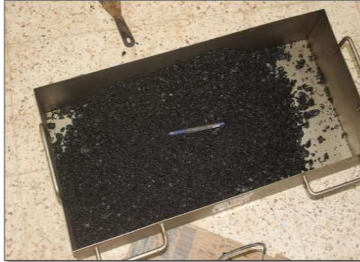
Fig. V.19. Mélange bitumineux après malaxage
