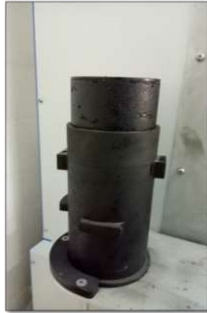
Fig. V.8. Essai la presse à cisaillement giratoire Fig. V.9. Extraction d'éprouvettes de PCG
