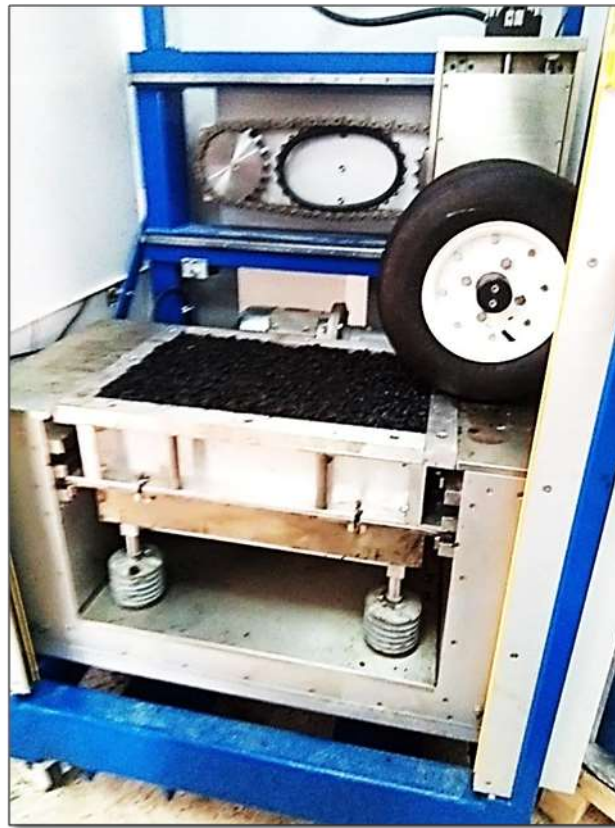
Fig. V.23. La plaque dans le compacteur
