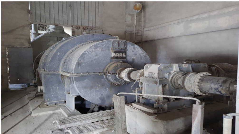
Figure 3.18 : réducteur épicycloïdal cimenterie tebessa
