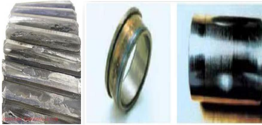
Figure : 4.12 : Défauts de l'usure [51]
