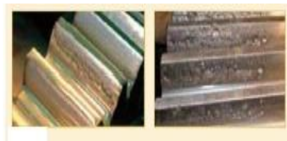
Figure 4.13 : Défauts de piqûre [47]
