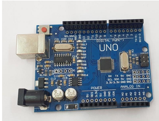
Figure V.6 Présentation de la carte Arduino UNO.
