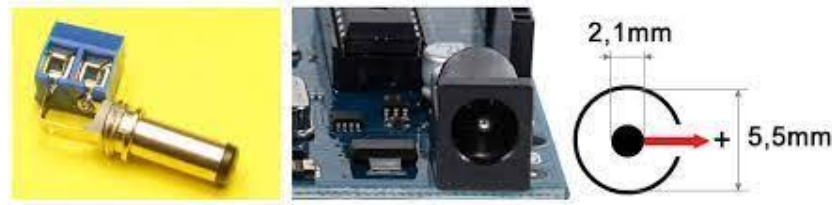
Figure V.7 Alimentation de la carte Arduino.
