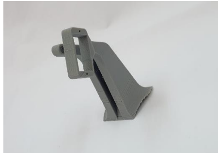
Figure V.45 La réalisation de bras de châssis.
