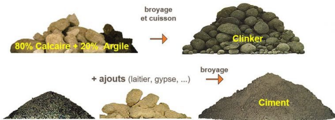
Figure 12. les grandes étapes de la fabrication du ciment.[23]
