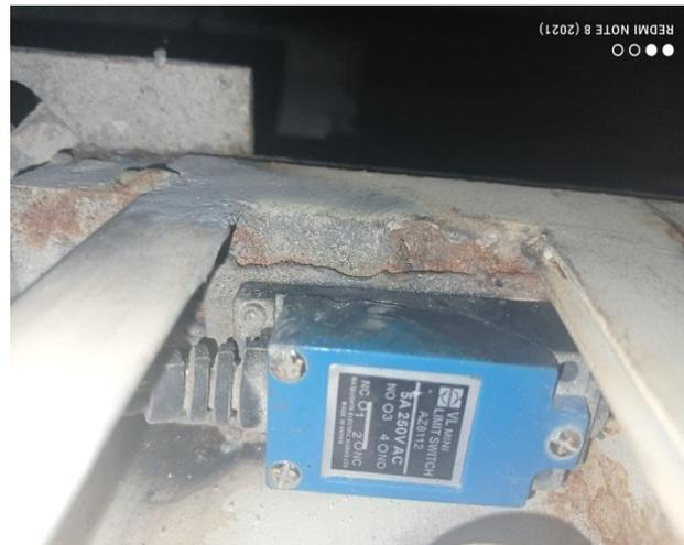
Figure IV.37. Capteur de fermeture de la porte.
