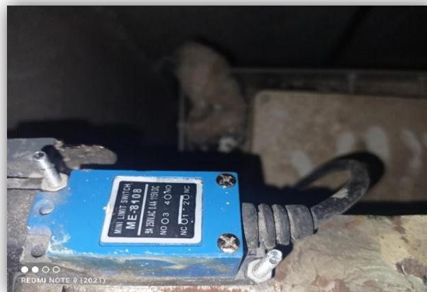
Figure IV.24. Capteur de fin de course bas.
