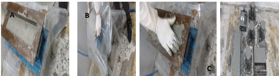
Figure II.33 moulage le béton(A) la table vibrante(B) les moules final de béton(C)
