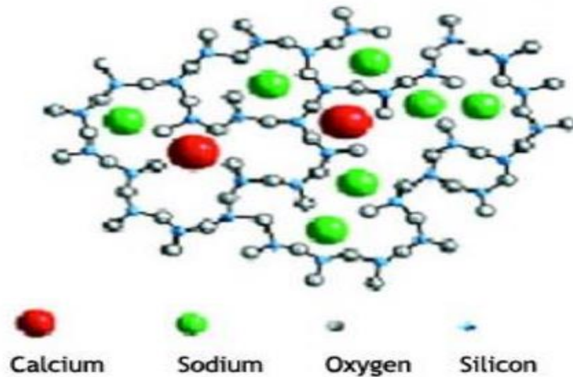
Figure I.2 : Matières premières entrant dans la composition du verre (I.A.Kassem, H. I.Al-khatib, I.S.Fathi)
