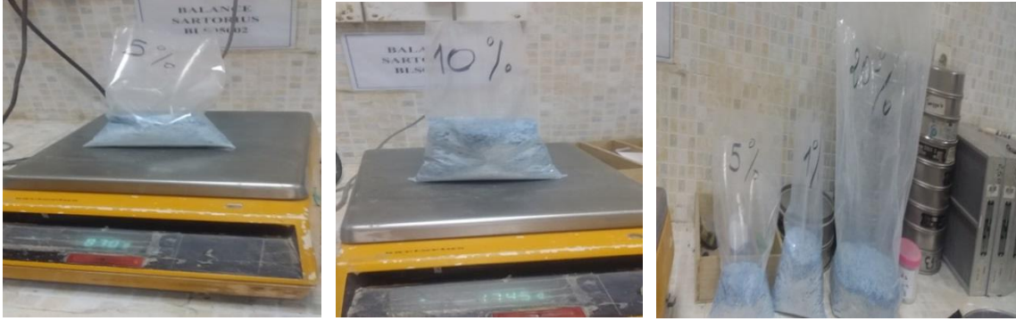
Figure II. 28 Mesurer la quantité de poudre de verre
