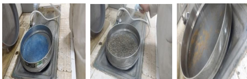
Figure II.13 : Laver les échantillons sur un tamis de 0,063 mm
