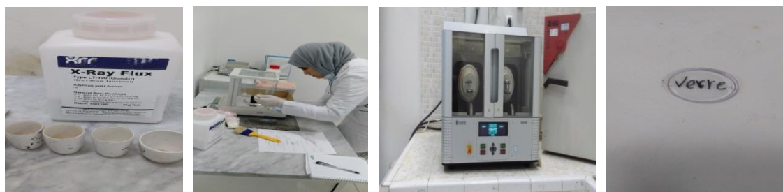
Figure II.20 : Préparation des échantillons, appareil utilisé et perle de verre obtenue
