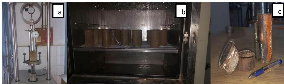
**Figure III.18** : Appareils utilisés pour préparer et réaliser l'essai en compression simple sans confinement.
