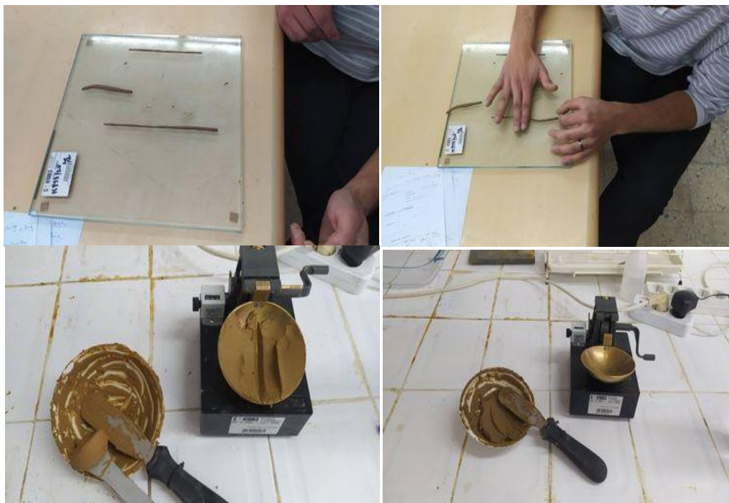
Figure 20 : Quelques photos de l'essai de limite d'atterberge
