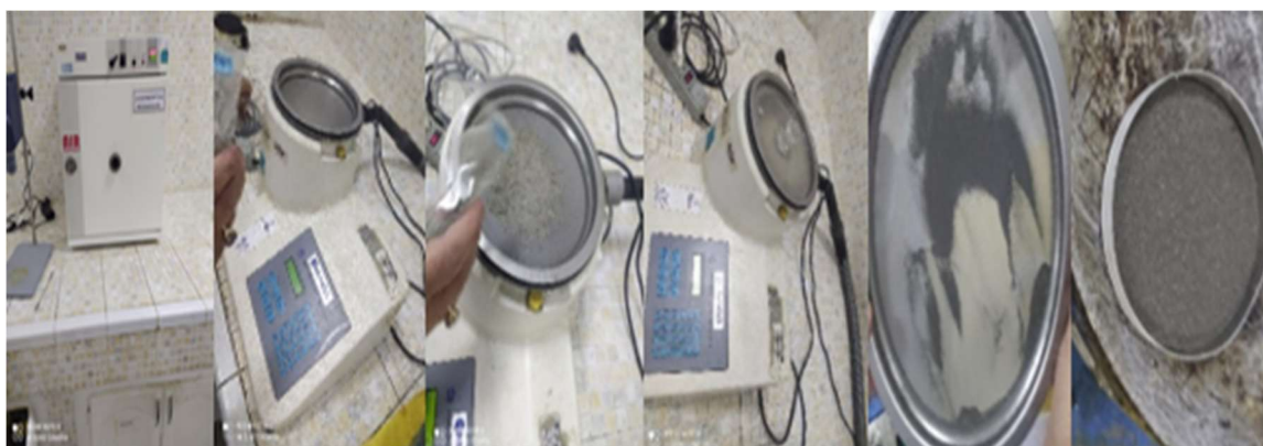
Figure III.15. Étape opératoire pour vérification de Refus sur tamis
