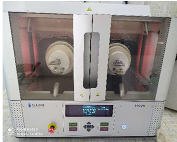
Figure III.19. Dispositif de préparation de la perle.
