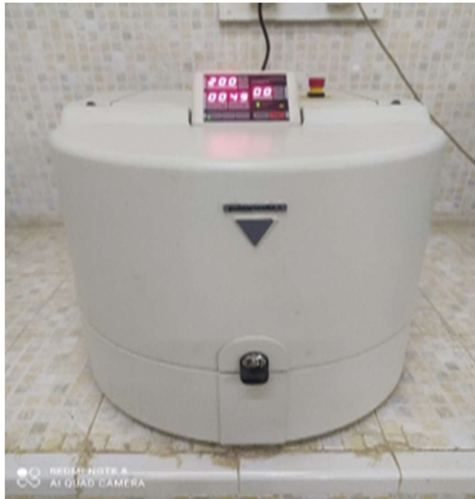
Figure III.6. Broyeur spécial pour échantillons d'analyse.
