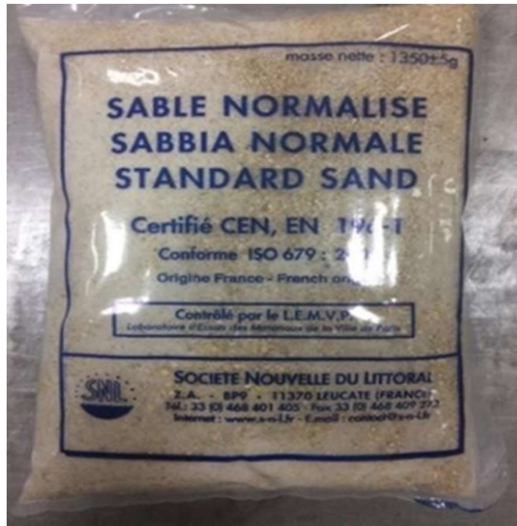
Figure III.4. Sable normalisé conformément à la norme EN 196-1.
