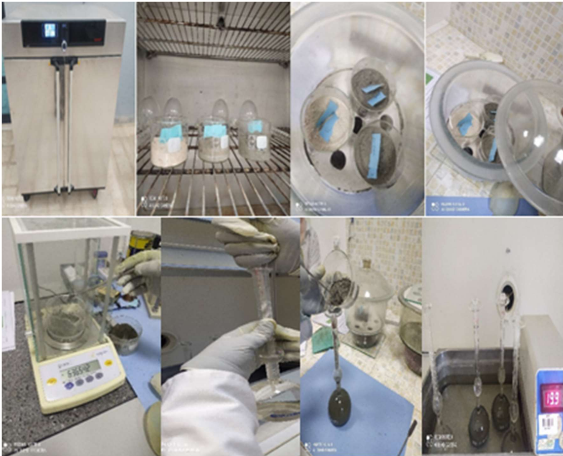
Figure III.10. Étapes de travail pour la mesure de la masse volumique absolue.
