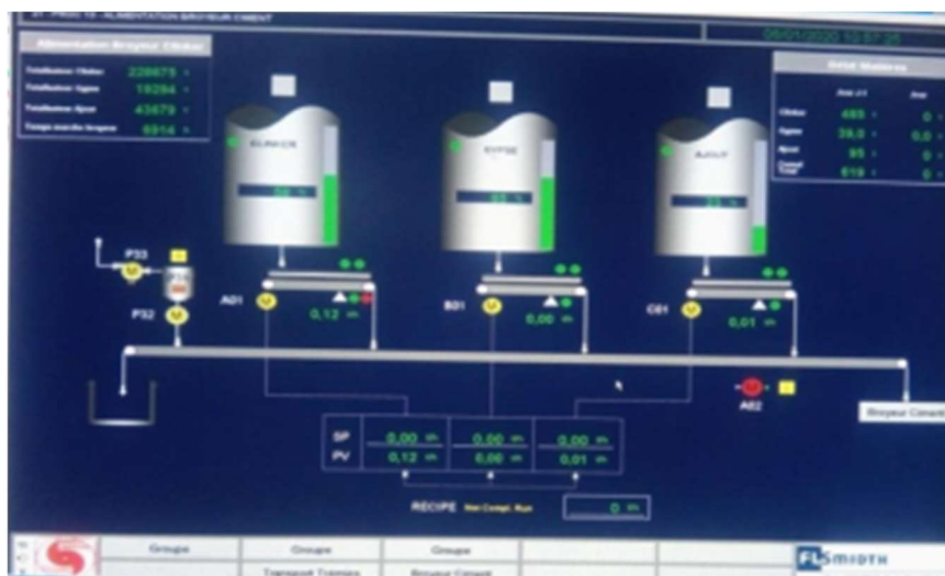
Figure II.28. L'alimentation du broyeur ciment.
