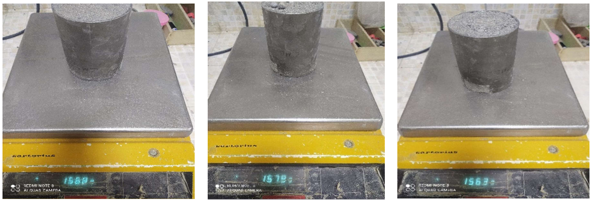
Figure III.9. Mesurer de la masse volumique apparente.
