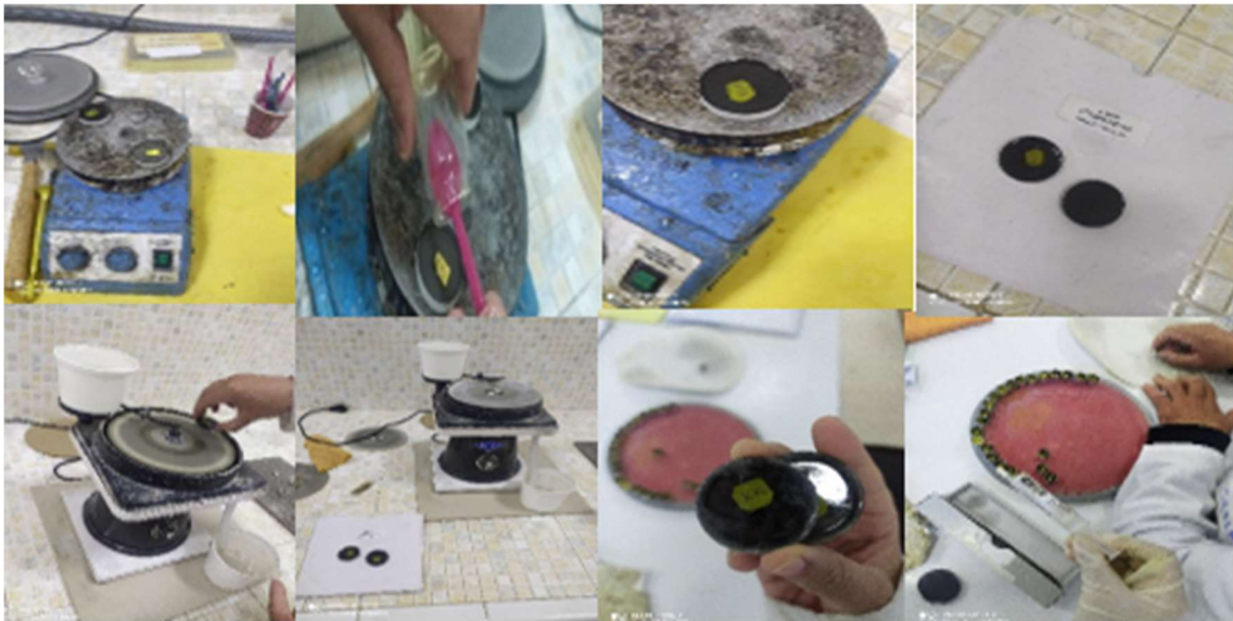
Figure III.16. Étape opératoire pour ajout d'un liquide pour solidifier l'échantillon.
