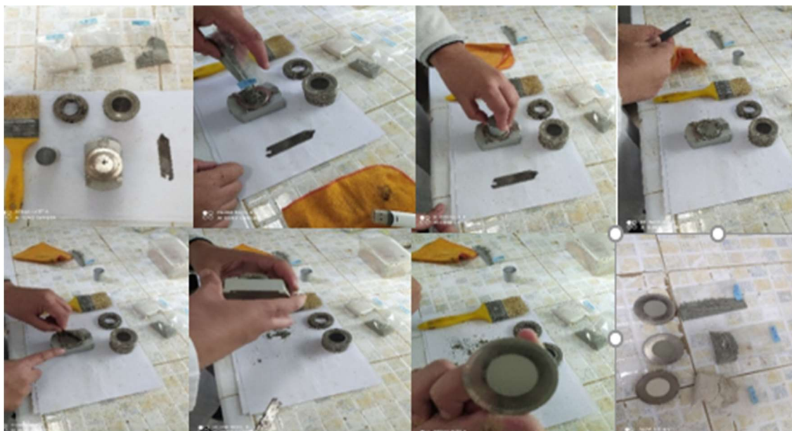
Figure III.13. Étapes du Préparation de la pastille des échantillons.
