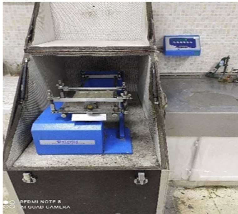
Figure III.32. Table à chocs pour Prisme de Moule.
