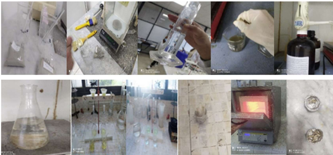
Figure III.25. Étape La Détermination de Le résidu insoluble du clinker.
