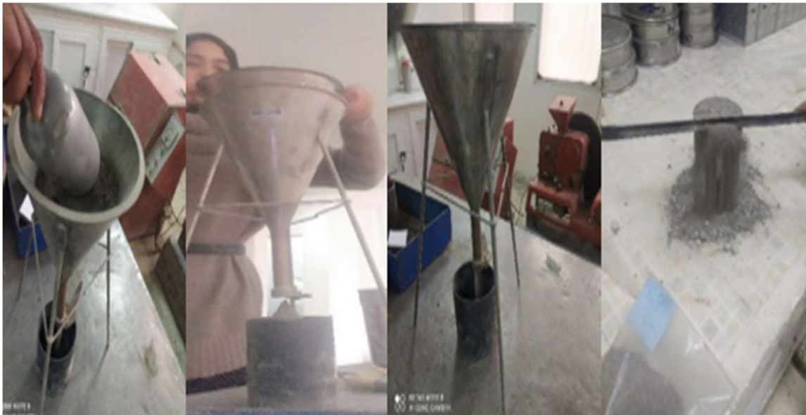
Figure III.8. Étapes de mesure de la masse volumique apparente.
