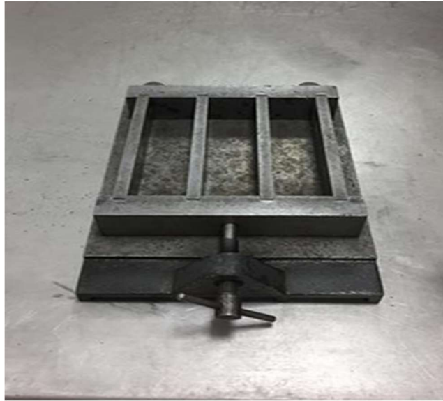
Figure III.31. Moule à 3 compartiments pour mortier 4 x 4 x 16 cm.
