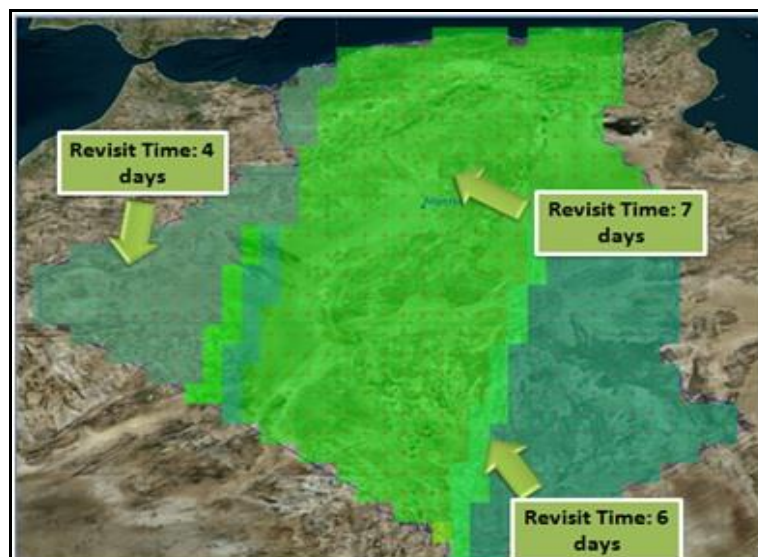
Figure 25: Optimisation du temps de revisite de la mission Alsat-1B, avec une couverture totale du territoire national en 29 jours.
