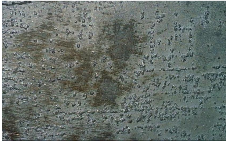
Figure.III.15: la morphologie de surface d'acier revêtu en absence de l'additif.
