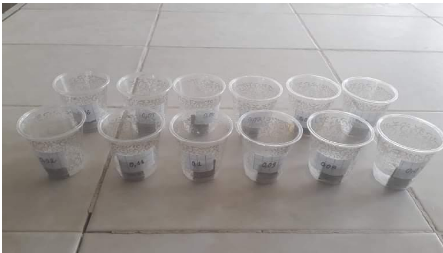
Figure III.11: représentation de l'étude gravimétrique dans l'eau de mer des aciers électroposer .
