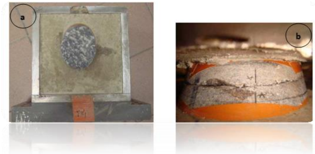
Figure 23 : Exemple de joint de calcaire scellé en place, essai réalisé au LRPC de Toulouse
