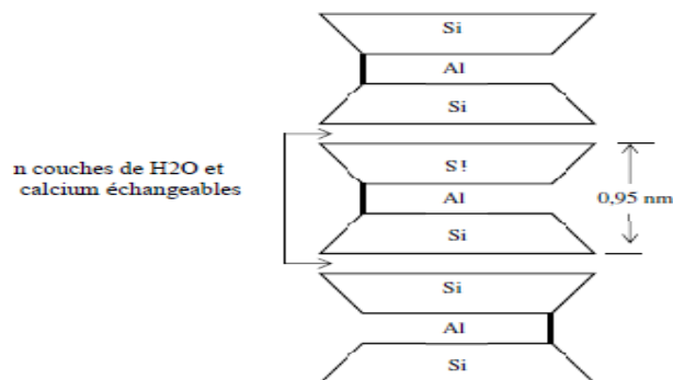
Figure 2.23 : Schéma de la structure de la montmorillonite [Lambe 1953].
