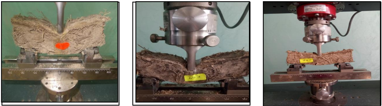
Figure 4.20 Essais de flexion des composites argileux de fibres normales élaborés à la table à choc.
