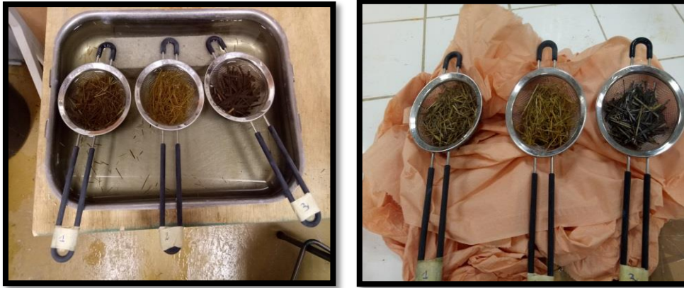
Figure 2.12 : Essai d'absorption des fibres. Figure 2.13 : Essuyage des fibres par immersion.
