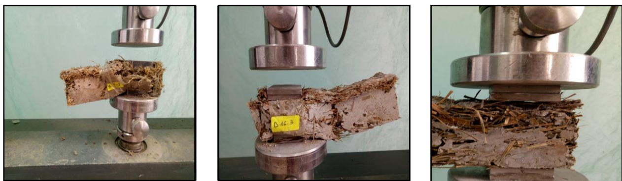
Figure 4.18 Essais de compression des composites cimentaires de fibres prémouillées élaborés par précompression.
