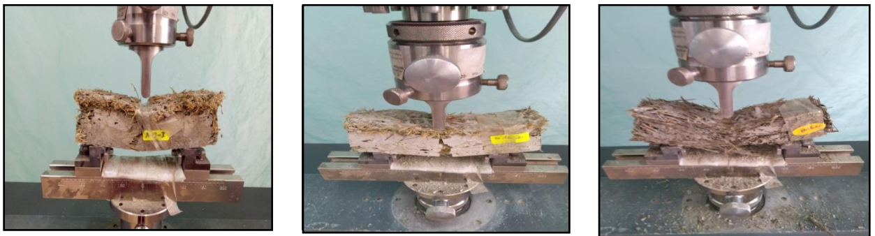
Figure 4.27 Essais de flexion des composites argileux de fibres prémouillées élaborés par précompression.
