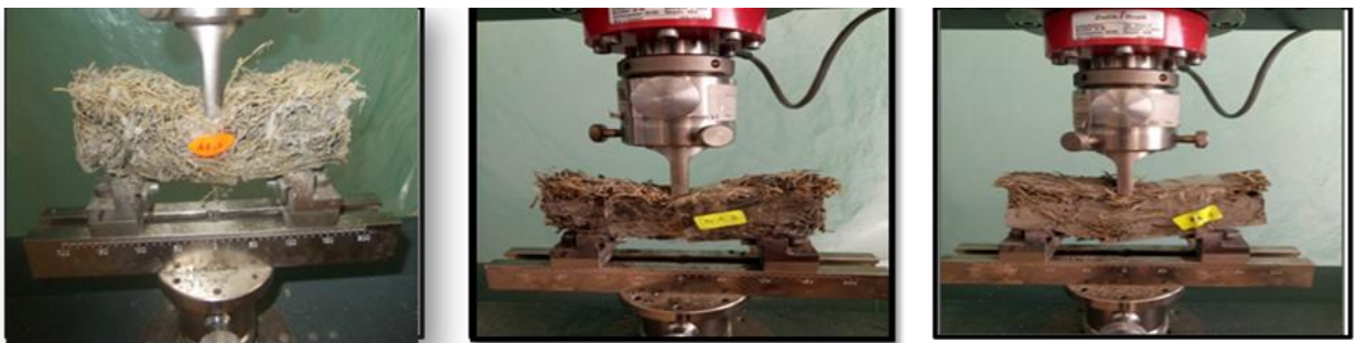
Figure 4.8 Essais de flexion des composites cimentaires de fibres normales élaborés à la table à choc.
