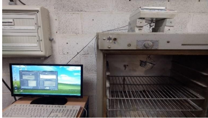
Figure 2.16 : Essai de séchage des fibres (Alfa, Diss et Palmier).
