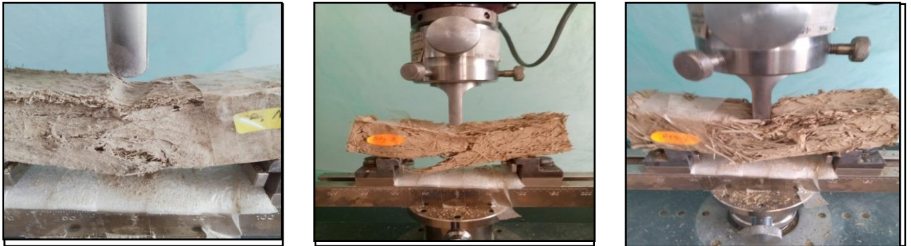
Figure 4.26 Essais de flexion des composites argileux de fibres normales élaborés par précompression.
