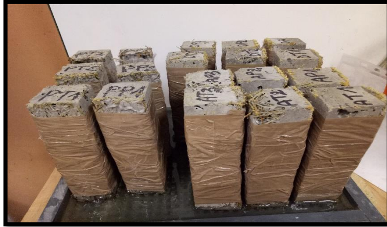
Figure 2.15 : Essai d'absorption d'eau par capillarité (Alfa/Ciment, Diss/Ciment et Palmier/Ciment).
