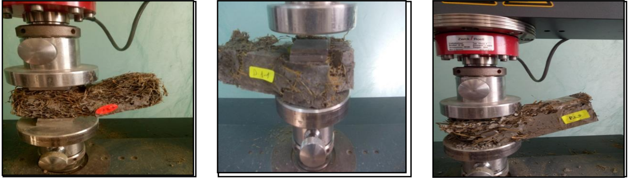
Figure 4.11 Essais de compression des composites cimentaires de fibres normales élaborés à la table à choc.
