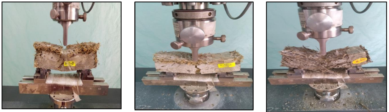
Figure 4.15 Essais de flexion des composites cimentaires de fibres pré mouillées élaborés par précompression.
