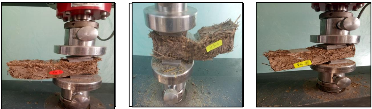
Figure 4.23 Essais de compression des composites argileux de fibres normales élaborés à la table à choc.
