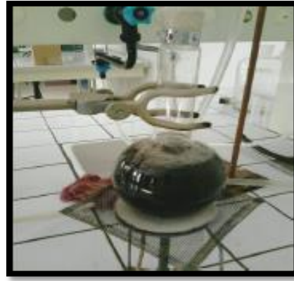
Figure 1.8: Hydrolyse par reflux.
