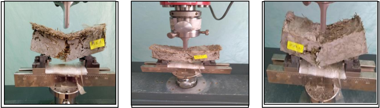
Figure 4.14 Essais de flexion des composites cimentaires de fibres normales élaborés par précompression.
