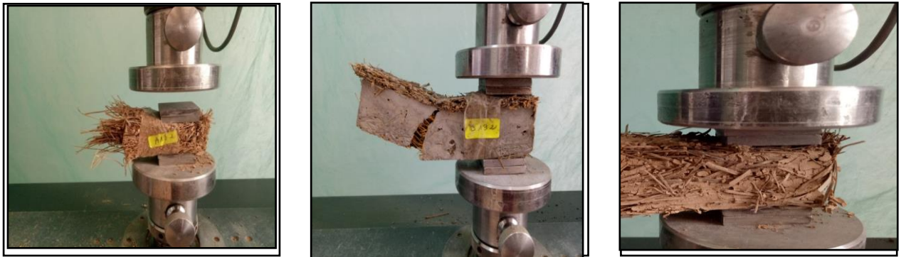
Figure 4.29 Essais de compression des composites argileux de fibres normales élaborés par précompression.
