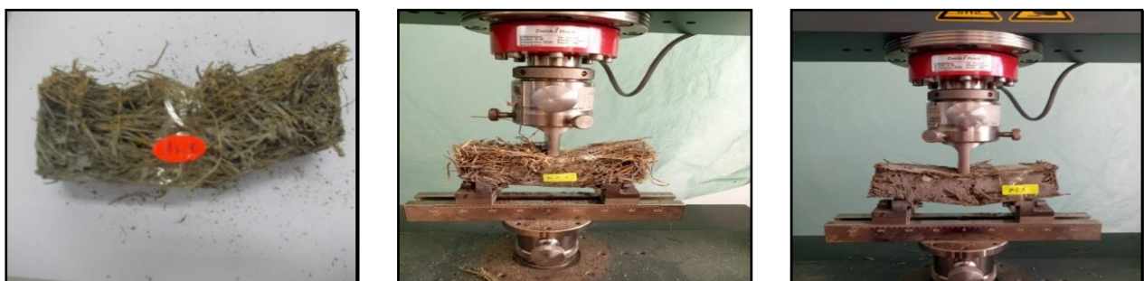
Figure 4.9 Essais de flexion des composites cimentaires de fibres prémouillées élaborés à la table à choc.
