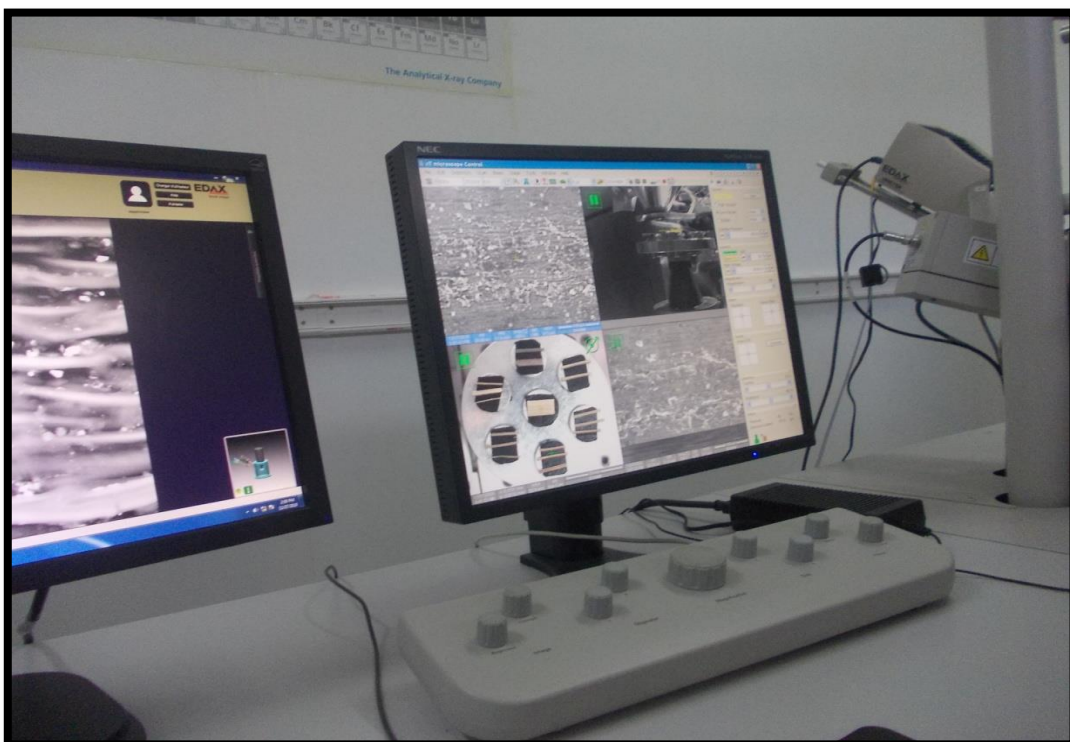
Figure 3.2: Ecrans associés pour visionnage des images au MEB et analyse chimique.
