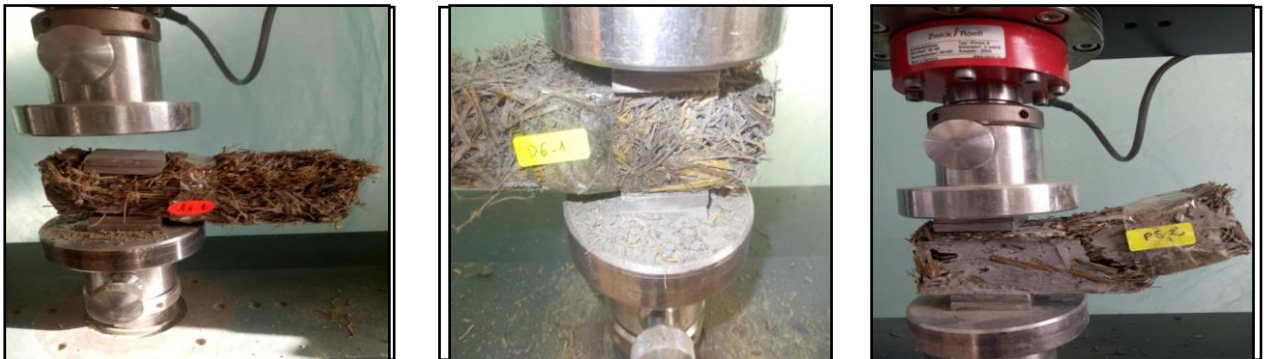
Figure 4.12 Essais de compression des composites cimentaires de fibres prémouillées élaborés à la table à choc.
