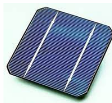
Fig. 1.8 : Représentation schématique d'une cellule solaire
