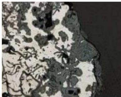
**Figure I.10 :** Corrosion sélective.
