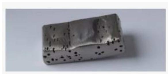
Figure I.5 : Corrosion par piqûres.
