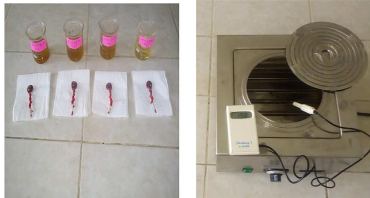
**Figure II.1** : Appareillage et préparation des solutions lors de la méthode gravimétrie.
