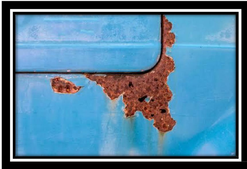
**Figure I.3 :** Corrosion localisée.
