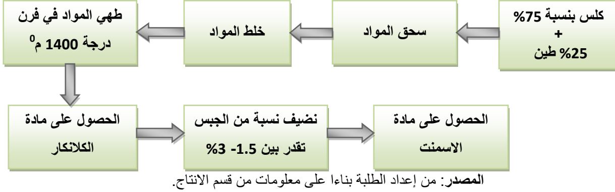
الشكل رقم (04) مراحل صناعة الاسمنت
