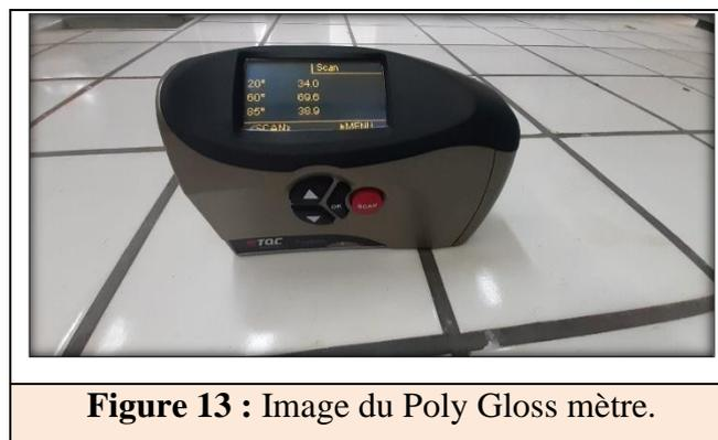
La lecture des valeurs mesurées sur l'appareil se fait par l'angle et l'estimation de la brillance se fait en se référant au tableau 1.
