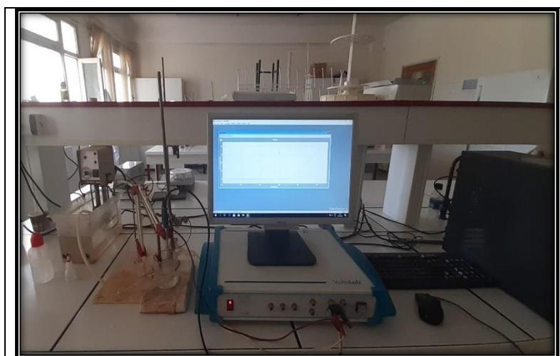
**Figure 10 :** Dispositif de mesures électrochimiques.
