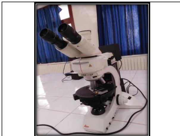
**Figure 14 :** Microscope optique polarisant.
