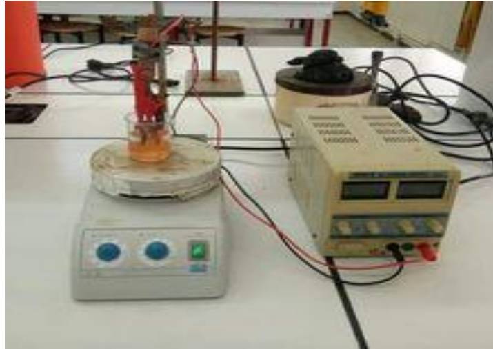
Figure II. 13 : Montage d'électrodéposition (Photo personnelle 2021).
