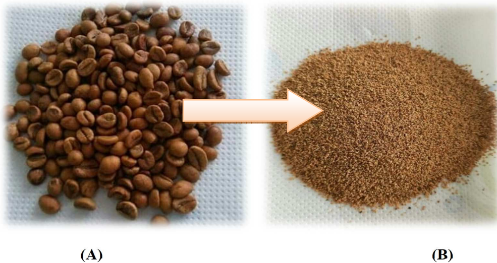
Figure IV.2: (A) Grains du C.Ara après séchage 24 h à 110 °C, (B) Grains du café broyés et tamisés.
