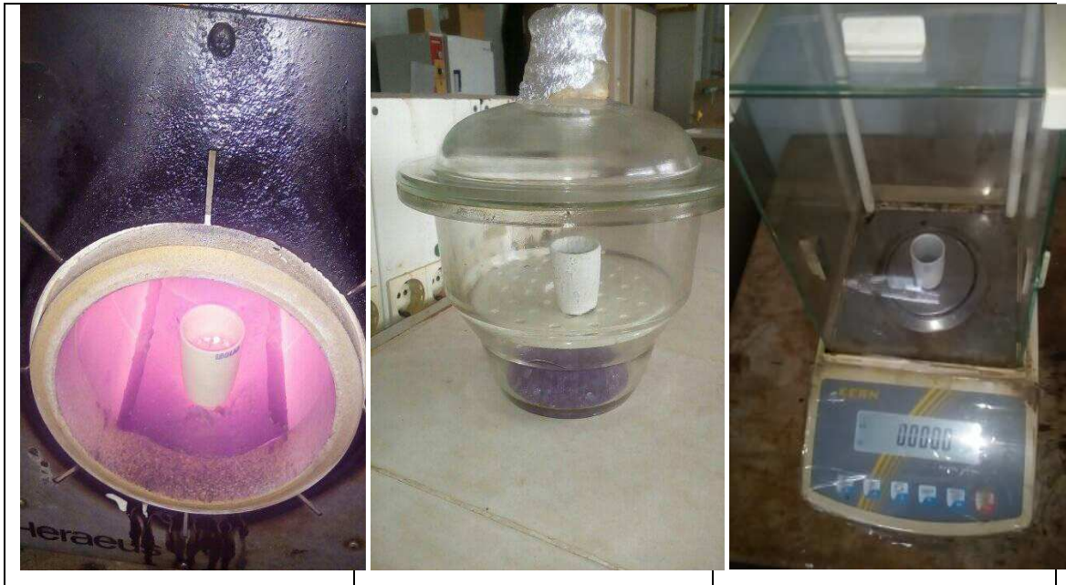
Figure IV.8: Détermination de taux de cendre.
