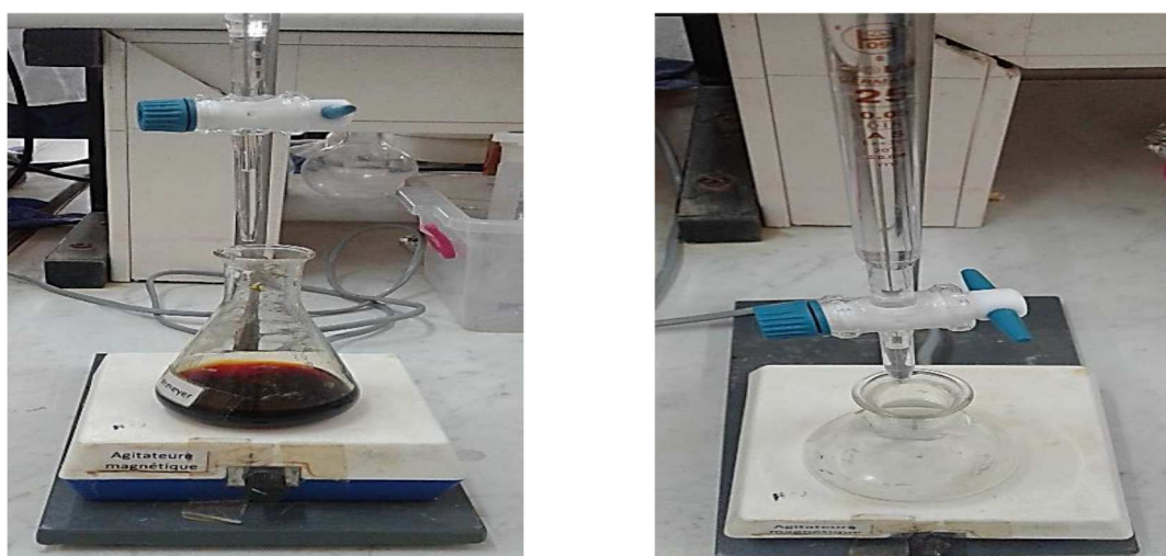
Figure IV.9: Détermination de l'indice d'iode par titrage avec la solution de thiosulfate de sodium
