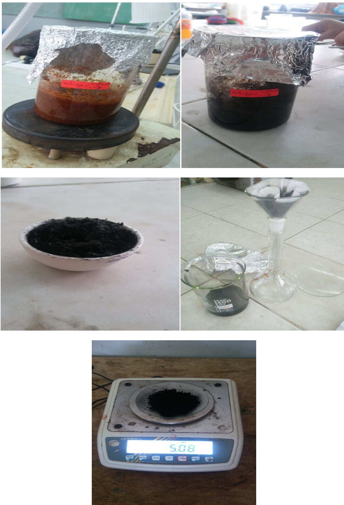
Figure IV.4: Les différentes étapes de l'activation chimique par l'acide phosphorique.
