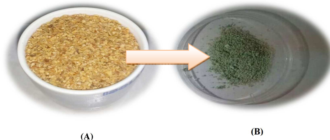
Figure IV.3: (A) Broyat de grain après la carbonisation, (B) le charbon carbonisé.
