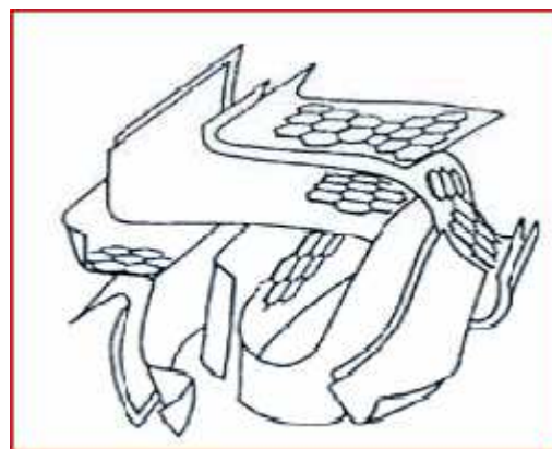
Figure I.7: Représentation schématique des microstructures du charbon actif [21].
