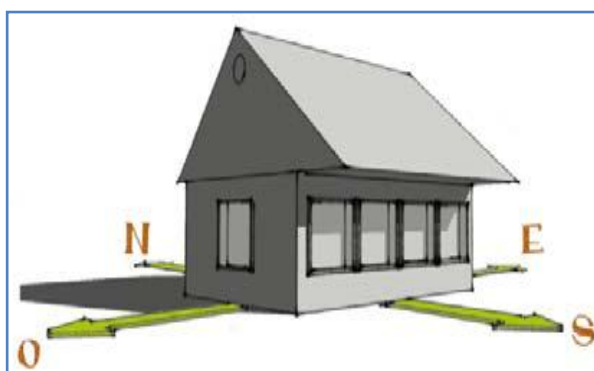
Schéma n° 60: Une façade vitrée exposée au sud. Source: Solaire passif, La maison solaire passive de A à Z. [ Eco-habitation. Canada],p: 07.
