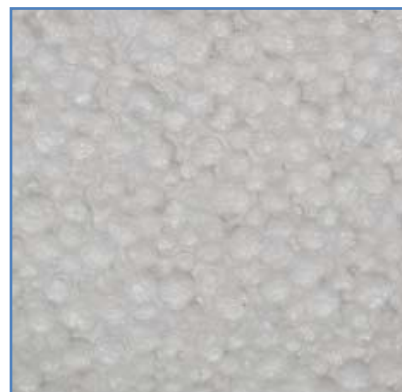
Photo n° 24: Le polystyrène expansé. Source : Guide de l'éco-construction, Agence régionale de l'environnement en Lorraine. [ADEME]. p:18.
