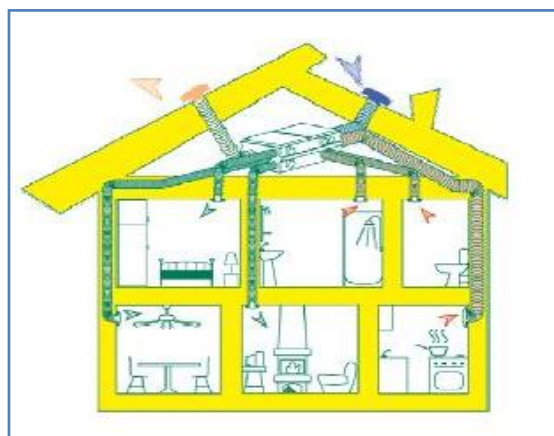
Schéma n° 28: Mécanisme de fonctionnement de la VMC hygroréglable. Source: Présentation du label PASSIVHAUS. [Mémoire Formation QEB 09/10 – Dorothee Tochon Fremont & Sebastien Viret – Concept Passivhaus et étude de cas – ENSAL.], p:25.
