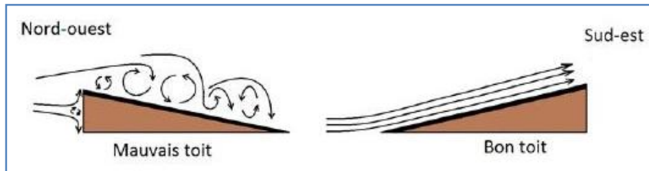
Schéma n° 64: La forme du toit de la maison passive. Source: Solaire passif, La maison solaire passive de A à Z. [ Eco-habitation. Canada],p:08.
