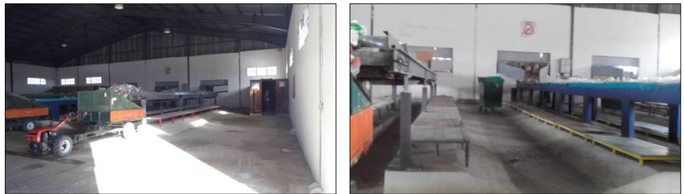
Photo 39-40: le tri des déchets ménagers sur tapis roulant
