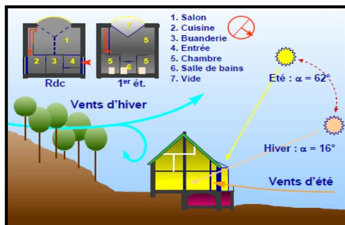
Figure 2-3: L'implantation tient compte du relief, des vents locaux, de l'ensoleillement.
