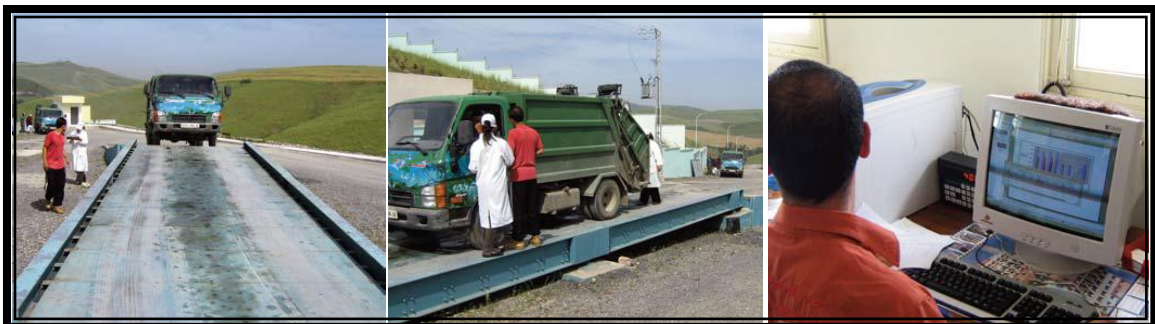
Photo 2 : Passage du camion à ordures sur le pont bascule pour et contrôle.
