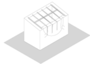
Schéma14 : poussée transmise par la couverture
