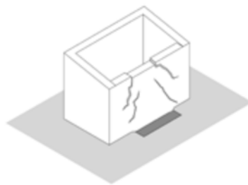
Schéma13 : l'affaissement des fondations (mur)
