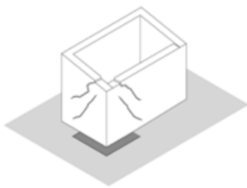
Photo32 : l'affaissement des fondations (angle)
