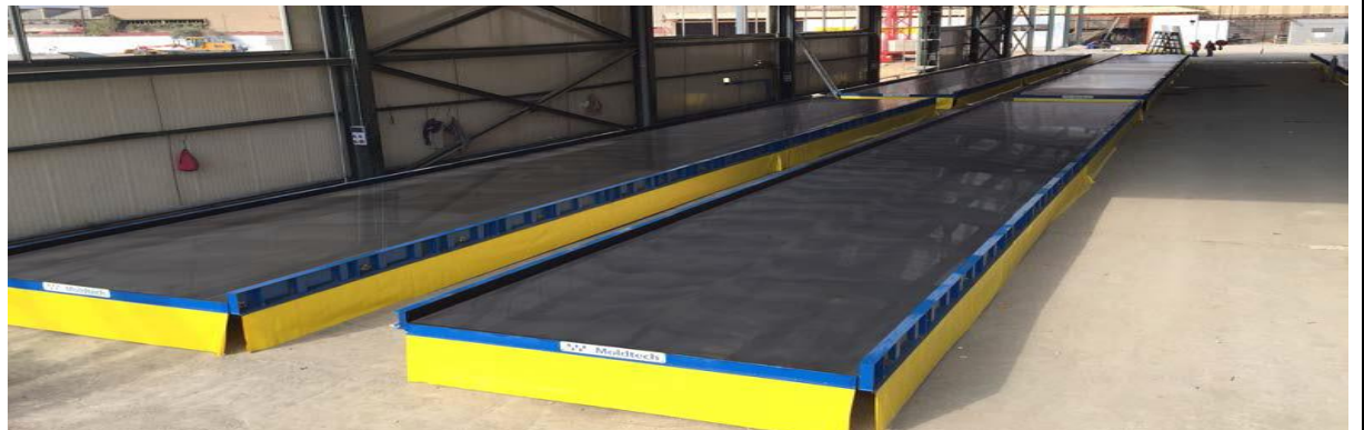
Fig.105: des exemples des moules predalles et installation sur chantier
