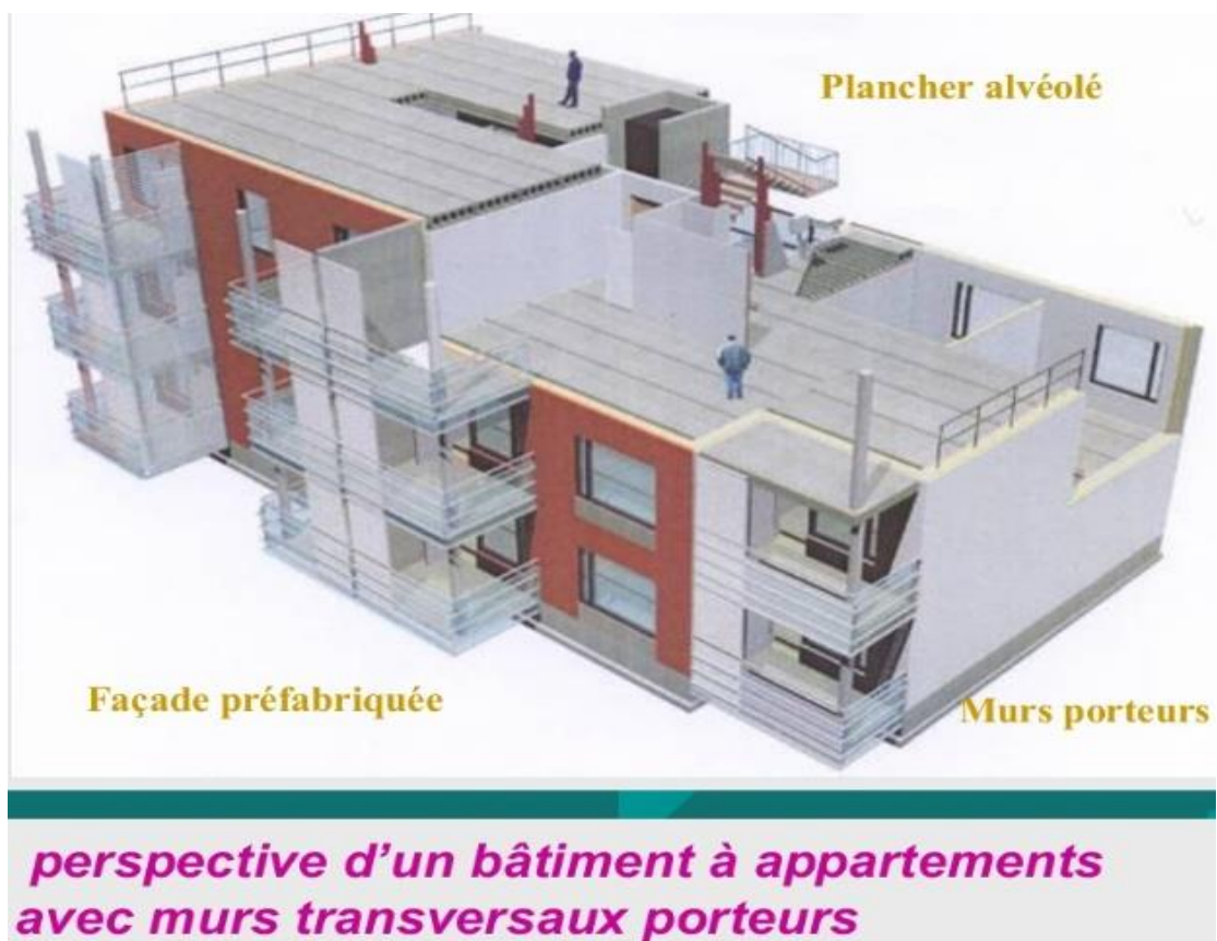
Figure35 : exemple Bâtiments à plancher alveole
