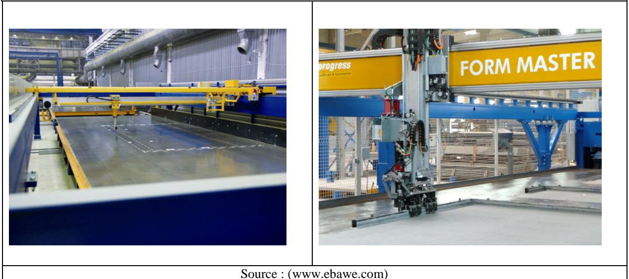
Fig.67: table de traçage et coffrage
