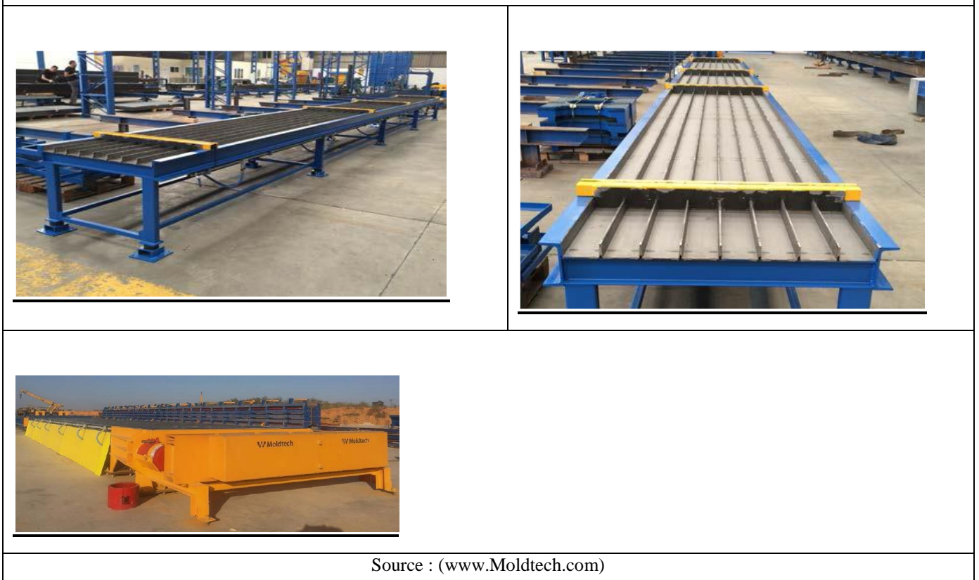
Fig.80: exemple Autres moules de batterie pour poutrelles armées
