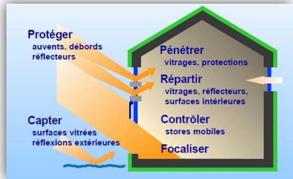
Figure 8: Strategie d'ouverture et de controle de la lumiere(source livre traite d'architecture et d'urbanisme bioclimatique pp 49b
