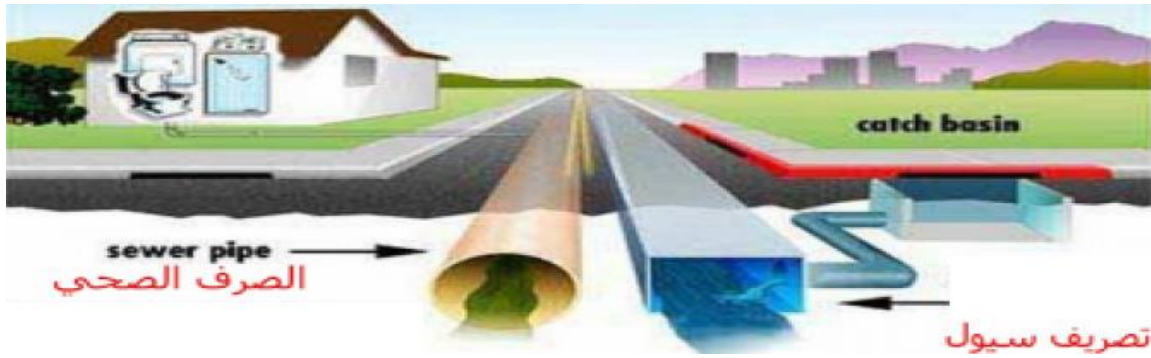
الشكل رقم 28: تصريف مياه الصرف الصحي.
