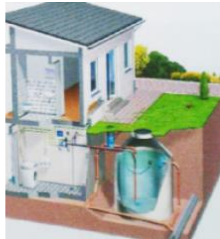
الشكل رقم 26: تجميع مياه الأمطار في المبني.
