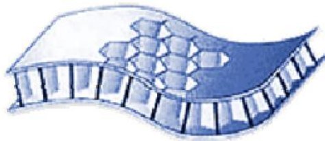
Figure 1.3 : Structure sandwich à âme Nida et peaux en stratifié
