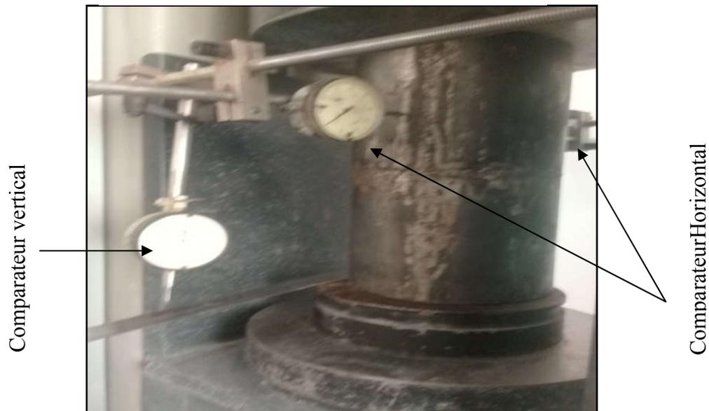
**Figure 2. 5** Configuration de l'essai de compression avec les comparateurs vertical et horizontal
