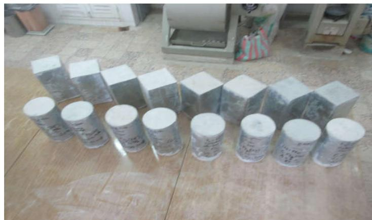
**Figure 4. 2** Spécimens remplis de béton
