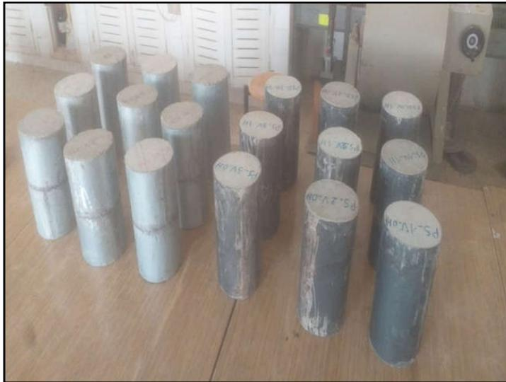
**Figure 2. 41** 8 tubes en aciers et en acier galvanisées soudés et remplis de béton
