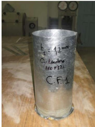
**Figure 2. 2**Coffrage de côté inférieure du poteau
