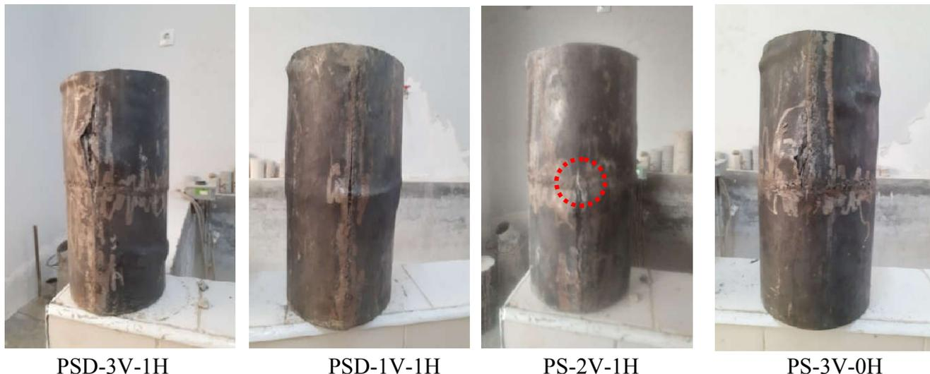
**Figure 2. 9** Mode de rupture des poteaux circulaires en acier remplis de béton
