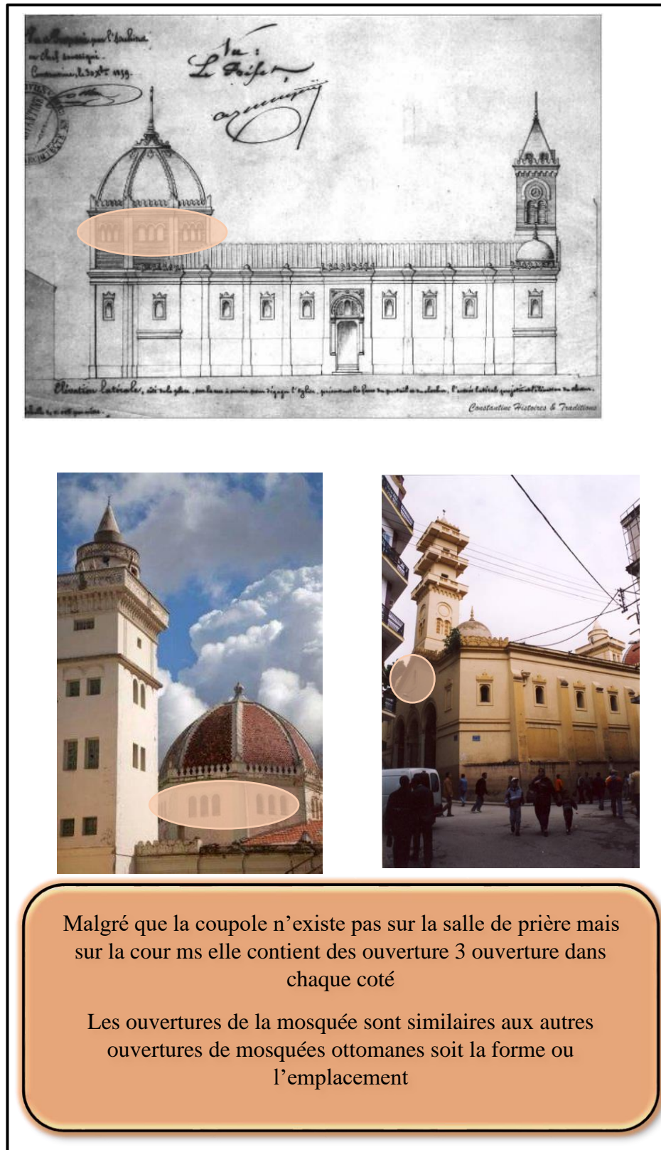
Figure42_les ouvertures de la mosquée Souk El ghazel_
