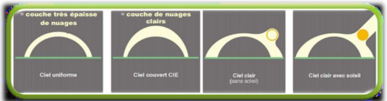
Figure 05 : Modèles de ciel. Source : BODART, M., 2002.
