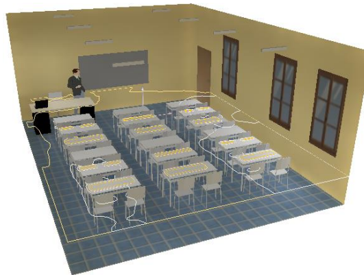
Figure46 : Les courbes des résultats de la simulation de la lumière dans le plan de travail
