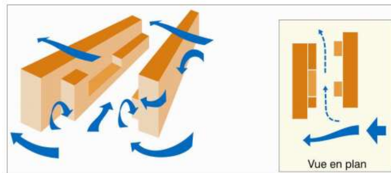
Figure 4-6 : Configuration de l'effet de bâtiments en quinconce.
