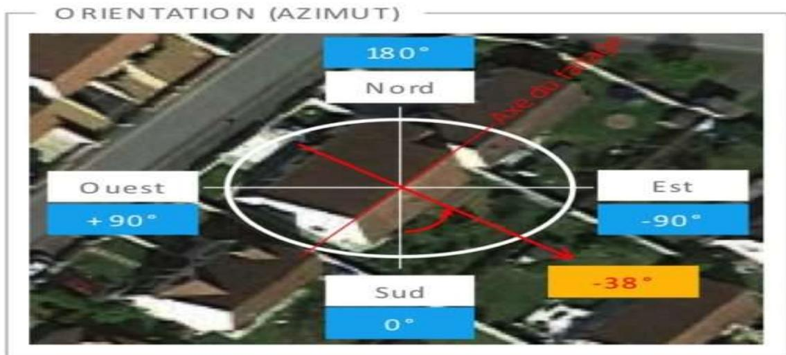
Figure3. 4 L'orientations des panneaux (Azimut)
