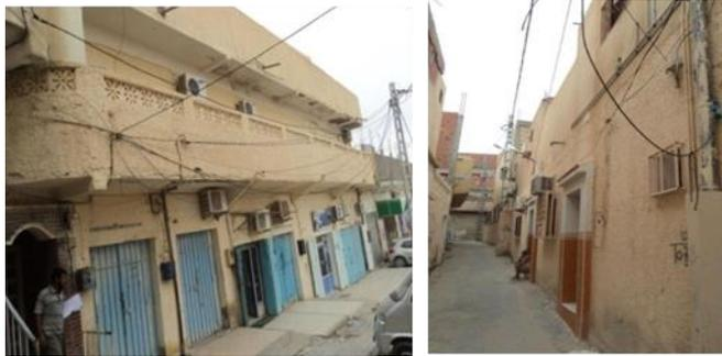
صورة رقم 45: توصيل سيء للكهرباء مما يجعلها تهدد سلامة الساكن خاصة عند نزول الأمطار، المصدر: إنجاز الطالب (Photoshop)، 2020/01/03.
