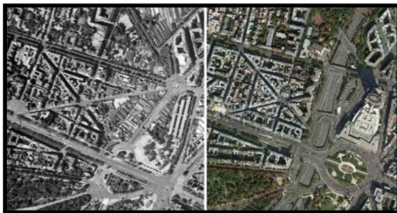
Figure 8: Le rognage du quartier des Sablons à Neuilly en France (Photo IGN 1955 et aujourd'hui). Un tissu urbain continu est devenu discontinu par la construction du boulevard périphérique en tranché. Source: © Atlas des paysages et des projets urbains des Hauts-de-Seine - Site mis à jour le 14 avril 2017.
