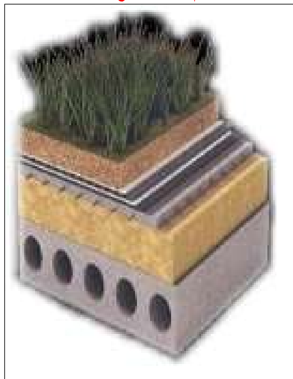
الشكل رقم 45: تقنية زرع الأسقف.
