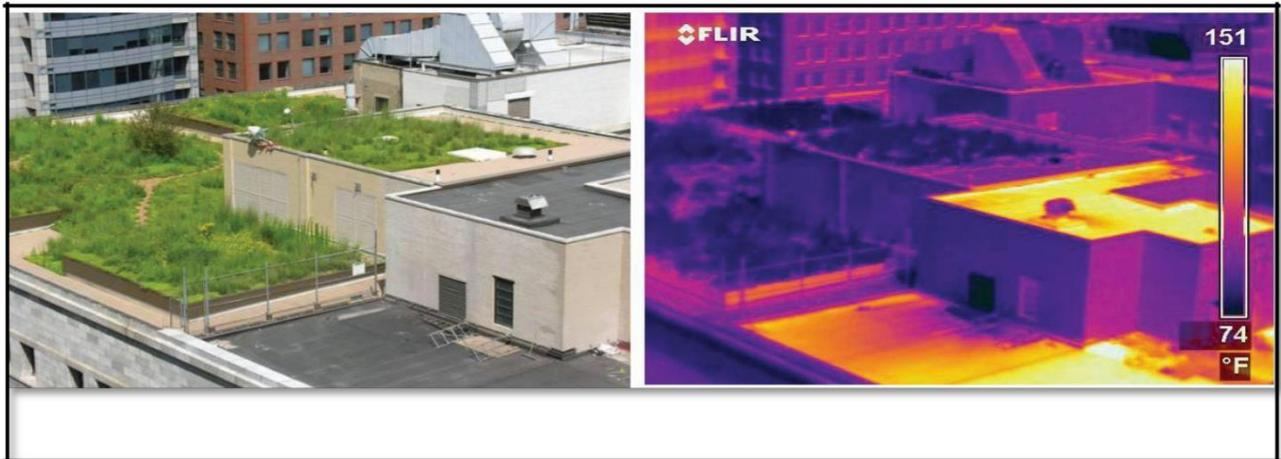
Figure 09 Mesure de la différence de température entre une toiture classique et une toiture végétalisée
