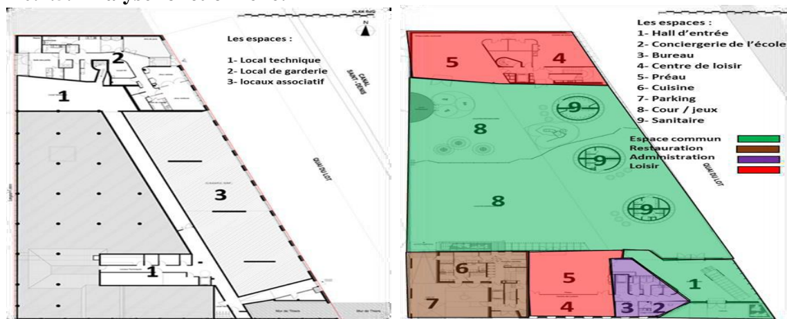
Fig N° 55: Analyse fonctionnelle du plan sous sol et RDC Source: Carles Broto, Centres pour l'éducation, LinksBooks, 2014, P.102
