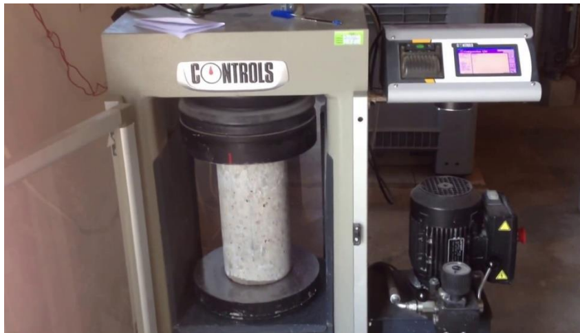
Figure II.4 Essai de la résistance à la compression
