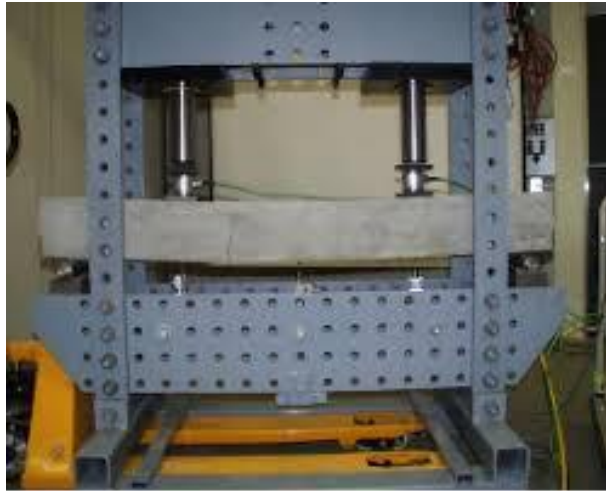
Figure II.5 Mesure de la résistance à la traction par flexion
