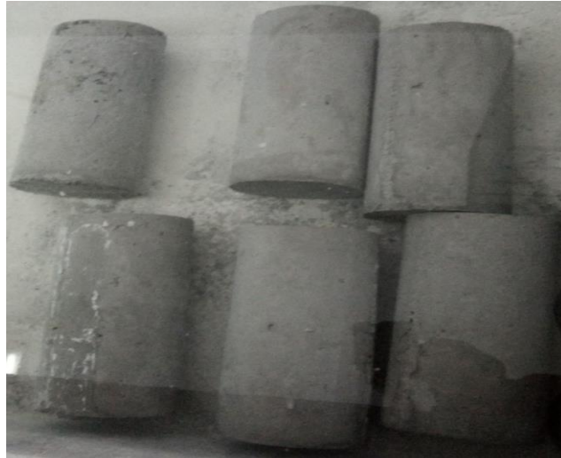
Photo V.17 les éprouvettes dans le bassin d'eau
