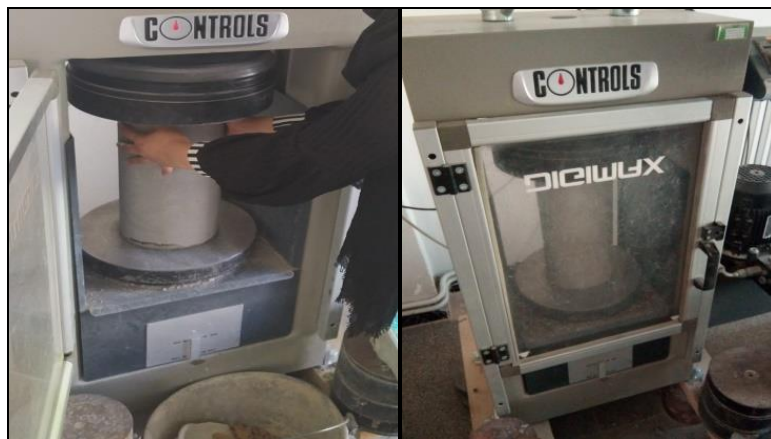
Photo V.20 La mise en place dans la presse
