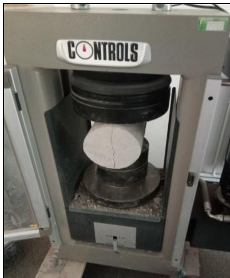
Photo V.23 La rupture de l'éprouvette
