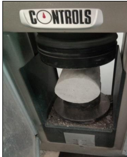
Photo V.22 La mise en place de l'éprouvette dans la machine
