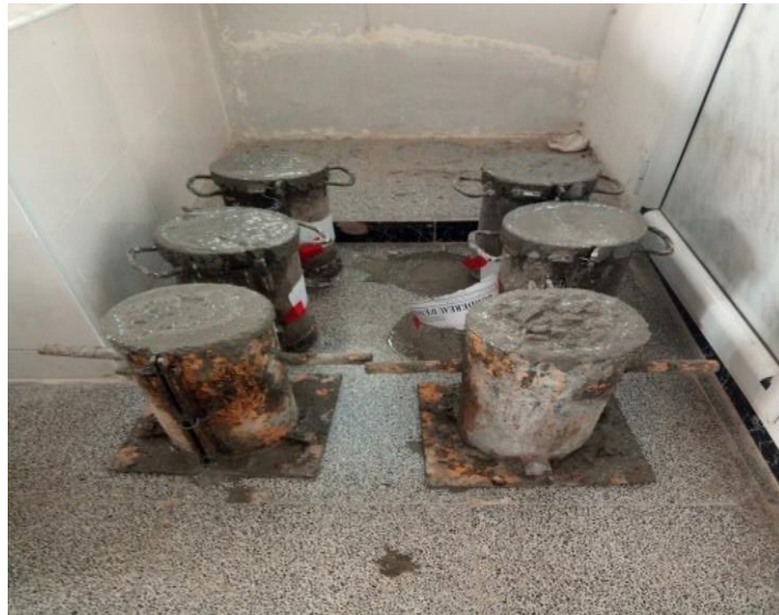
Photo V.15 Conservation des éprouvettes avant le démoulage
