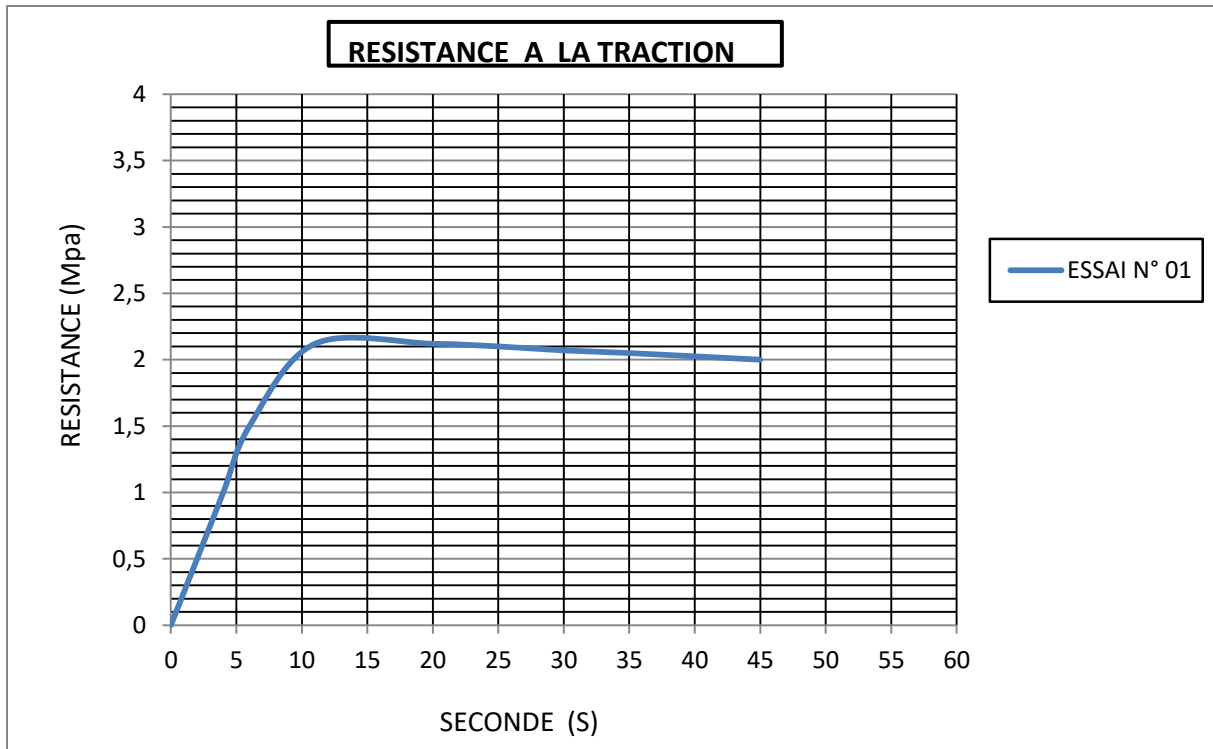
Figure VI.8 Résistance à la traction (BFP de 1 %)
