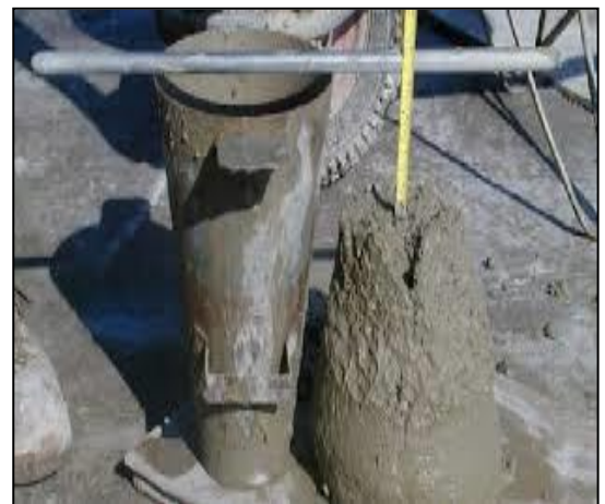
Photo V. 18 l'essai du cône d'Abrams
