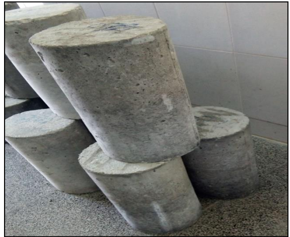
Photo V. 16 Démoulage des éprouvettes
