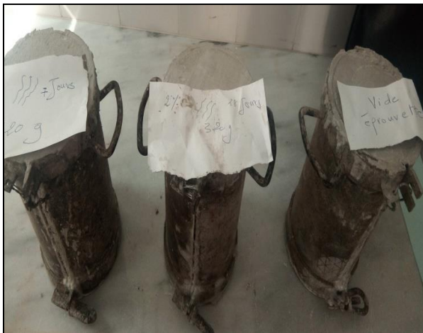
Photo V. 16 Démoulage des éprouvettes
