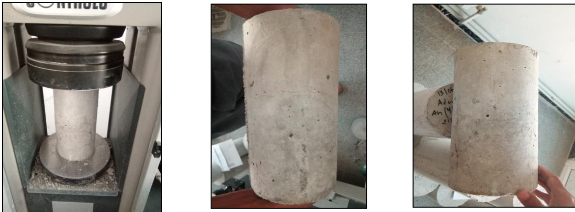
Photo V.21 La rupture de l'éprouvette
