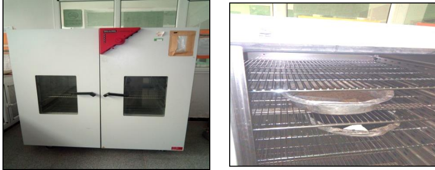
Photo V. 11 Séchage des échantillons dans l'étuve
