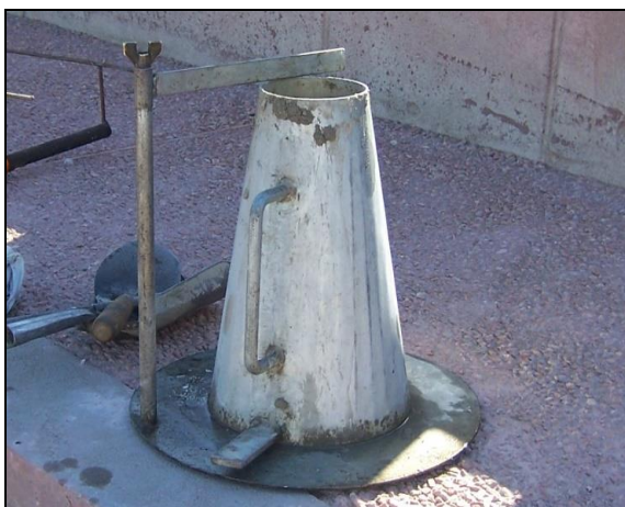
Photo V. 18 l'essai du cône d'Abrams
