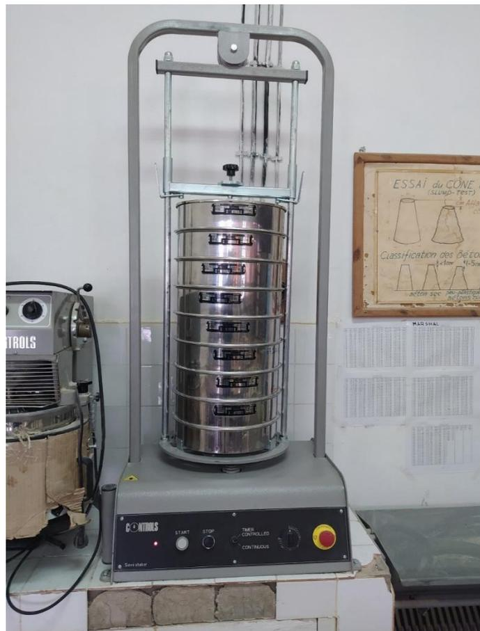
Figure II.2 : Machine de vibration des tamis pour l'Analyse granulométrique.
