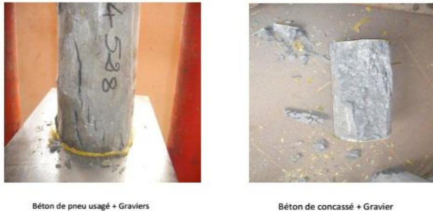
**Figure III.7 :** Eprouvettes après compression.
