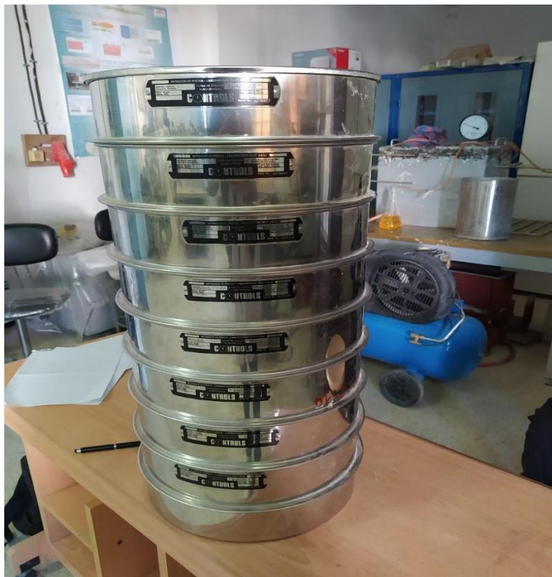
**Figure II.1 :** Appareillage spécifique (les tamis).
