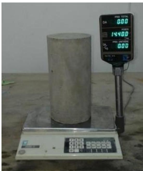
**Figure III.1 :** Mesure de la masse volumique des bétons à l'état durci.
