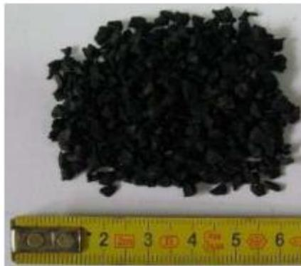
**Figure III.5 :** Granulats en caoutchouc de classe (0/4) mm utilisés [Ho, 10].
