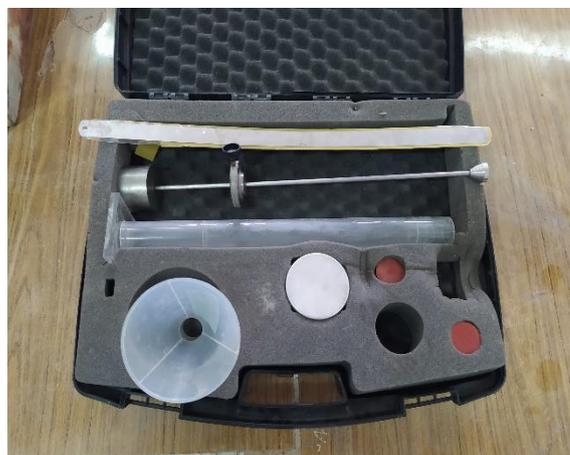
**Figure II.5 :** Appareillage d'essai equivalent de sable.
