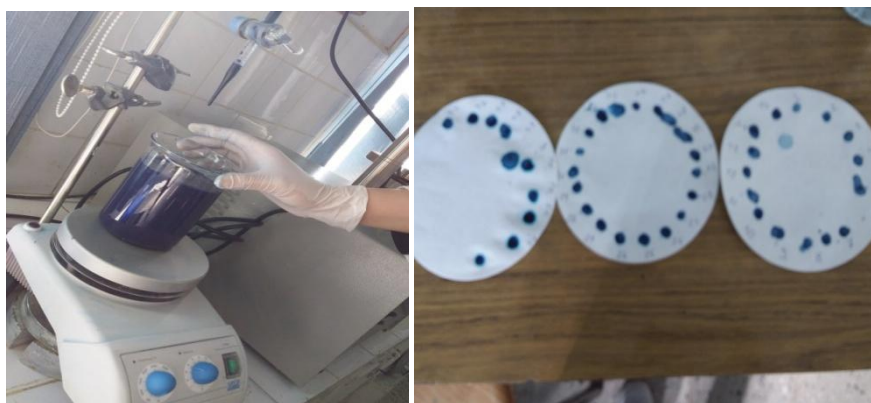
Figure4.16 les étapes d'essai bleu méthylène
