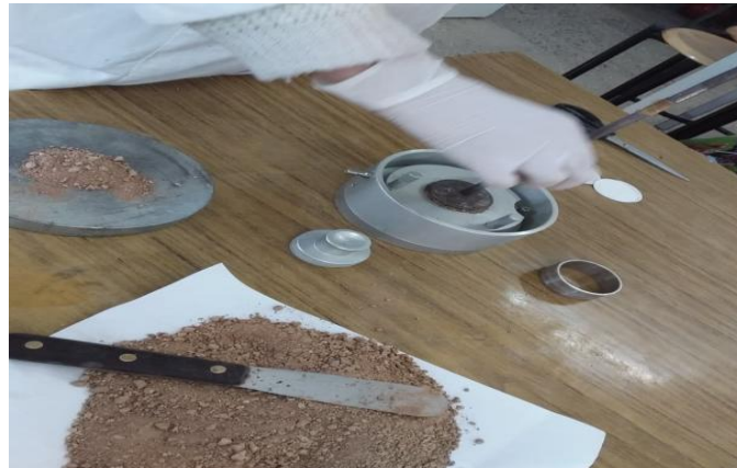
Figure 5.5 Emplacement du sol muni de l'anneau dans la cellule de l'œdomètre
