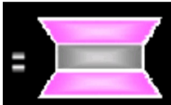
a-Schéma de la structure élémentaire de l'illite Lambe (1953)
