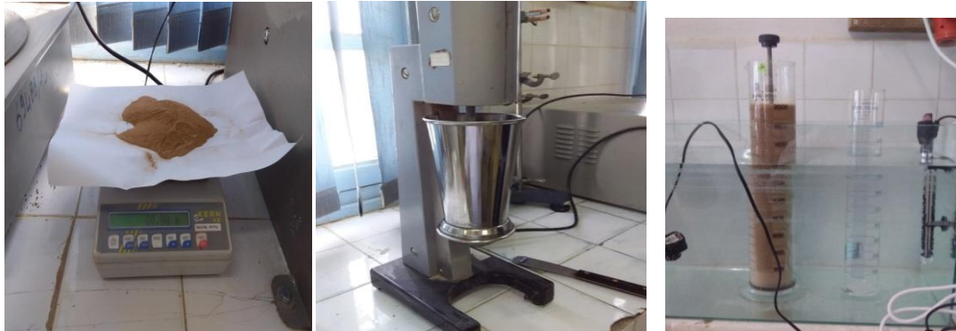
Figure 4.3 manipulation d'essai granulométrique par sédimentométrie
