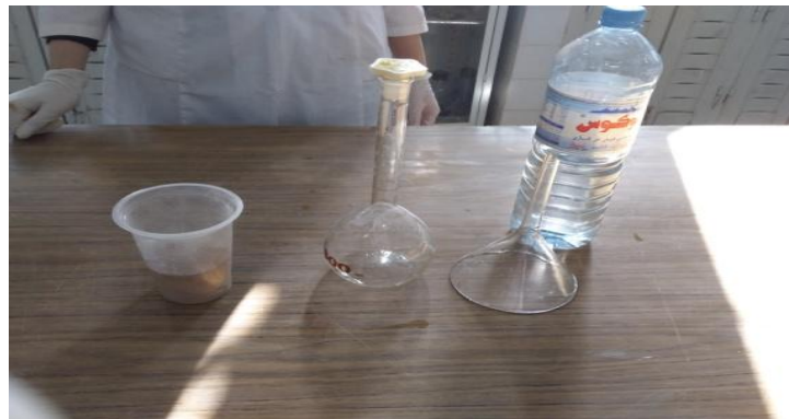
Figure 4.18 matériel utilisé dans l'essai de poids spécifique par pycnomètre
