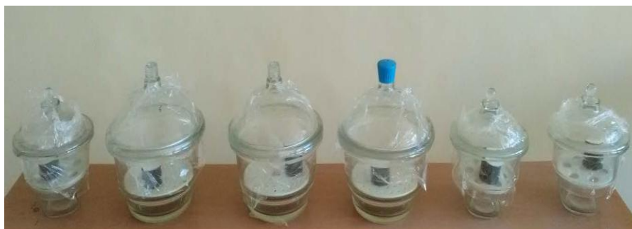
Figure 3.5 Mesure de la succion par la méthode du papier filtre.
