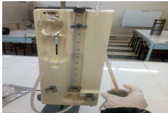
Figure 4.19 manipulation de l'essai calcimétrie
